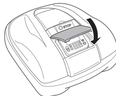
**3-5** Appuyez sur le bouton STOP. Le capot du clavier de contrôle s'ouvre. Le message « Test du retour à la station d'accueil » s'affiche.
