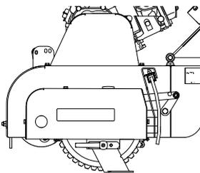
Bei der Betriebsaufstellung wird der Messerarm in die niedrigste Stellung gebracht und in dieser Stellung verriegelt. Der Antrieb des Messers ist in dieser Aufstellung eingeschaltet. Das Messer führt also etwa 1000 stechende Bewegungen pro Minute aus. In dieser Aufstellung besteht eine erhöhte Gefahr von Schnittverletzungen. Aus diesem Grund muss sich der Bediener immer in seiner Arbeitsposition hinter dem Lenkrad befinden.
