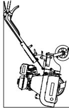
Für die Durchführung einer Kontrolle oder von Wartungsarbeiten darf die Maschine nur nach vorne gekippt werden (siehe auch § 11.4.2.2.).
