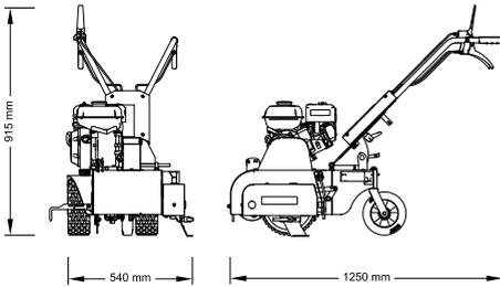
Abmessungen der Maschine (LxBxH in mm)
