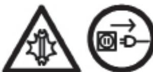
Dieses Piktogramm macht den Bediener darauf aufmerksam, vorsichtshalber stets die Maschine auszuschalten und den Stromstecker aus der Maschine zu ziehen, bevor eine Wartung des Messersystems vorgenommen wird. Dadurch wird verhindert, dass die während der Wartungsarbeiten, im Zuge derer der Bediener mit seinen Händen in die Nähe der Messer kommt, ungewünscht starten kann.
