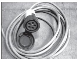
Nach dem Anschließen der Verlängerungsschnur ist die Drehrichtung der Messerwelle zu überprüfen. Wenn die Drehrichtung falsch ist, muss diese umgepolt werden (siehe dazu Anlage 4).
