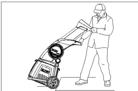
diese dann gleichmäßig auf die Schwelle, wenn der Höhenunterschied weniger als der Radius des Rades beträgt. Gehen Sie stets vorsichtig vor, um Schäden am Radrahmen zu vermeiden. Wenn die Schwelle höher als der halbe Raddurchmesser ist, muss man die Maschine auf die Erhöhung heben.
