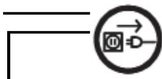
Ce pictogramme oblige l'utilisateur qui souhaite effectuer l'entretien du système des lames de toujours arrêter la machine et de retirer la fiche de la machine à titre de précaution. Cela permet d'éviter tout démarrage intempestif de la machine lors d'un entretien pendant lequel l'opérateur a les mains à proximité des lames.
