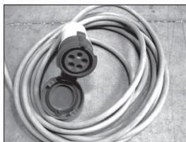
Après avoir branché le cordon d'alimentation, contrôlez le sens de rotation de l'arbre porte-lames. Si le sens de rotation n'est pas le bon, il convient de l'inverser (voir annexe 4)
