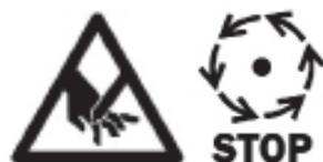
Ce pictogramme met l'utilisateur en garde contre le risque de coupures aux mains et l'oblige à attendre jusqu'à ce que les lames soient totalement immobilisées avant d'ouvrir la chambre de broyage. Une fois le moteur coupé, les lames continuent à tourner un certain temps en raison de leur inertie. C'est une situation dangereuse dont ce pictogramme avertit.
