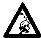
Gelände überprüfen: Feste Gegenstände – Steine, Metallteile, o. Ä. können weggeschleudert werden – **Verletzungs-gefahr!** – und können das Schneidwerkzeug sowie Sachen (z.B. parkende Fahrzeuge, Fensterscheiben) beschädigen (Sachbeschädigung).
