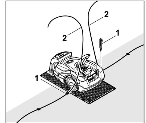
Den letzten Fixiernagel (1) links bzw. rechts neben der Bodenplatte, direkt neben dem Drahtauslass einschlagen. Begrenzungsdraht (2) auf ca. 1,5 m freie Länge abschneiden.
