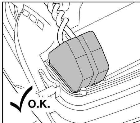
Retourner les passe-câbles sur les blocs de serrage.
