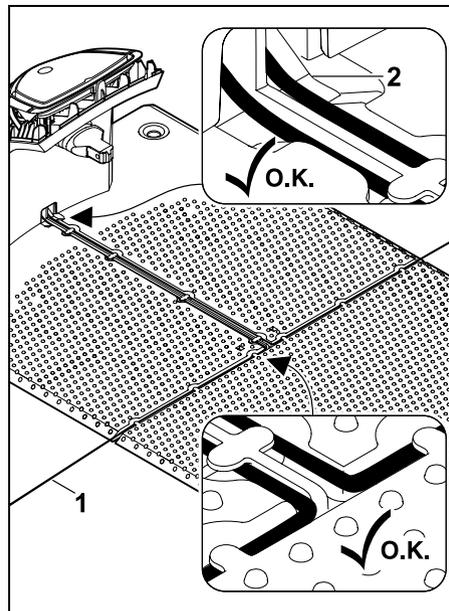
Placer le fil de délimitation (1) dans les guide-câbles de la plaque de base et le faire passer par le socle (2).
