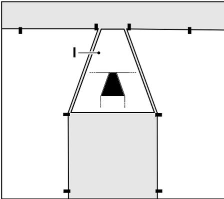
Voor het installeren van de trechervormige toegang en uitgang moet ook de meegeleverde doorgangensjabloon (I) worden gebruikt.
