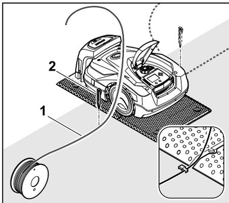
À l'aide d'un piquet de fixation (2), fixer au sol le fil de délimitation (1) à **gauche** ou à **droite** près de la plaque de base, directement à côté d'une sortie de fil.
