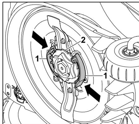
Enfoncer d'une main les deux languettes (1) au niveau du disque d'entraînement et les maintenir dans cette position. Dévisser l'écrou de fixation (2) de l'autre main. Retirer la lame de coupe avec l'écrou de fixation.
