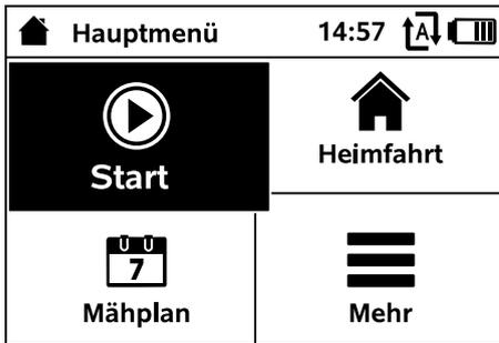
Das Hauptmenü besteht aus 4 Untermenüs, dargestellt als Schaltflächen. Das ausgewählte Untermenü ist schwarz hinterlegt und wird mit der OK-Taste geöffnet.
