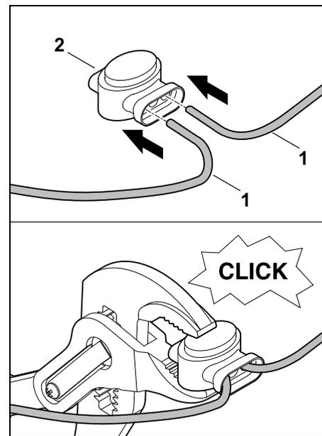
Steek losse, niet gestripte draaduiteinden (1) tot aan de aanslag in draadverbinders (2). Druk draadverbinders met een geschikte tang bij elkaar – ga na of ze goed vastklikken.
