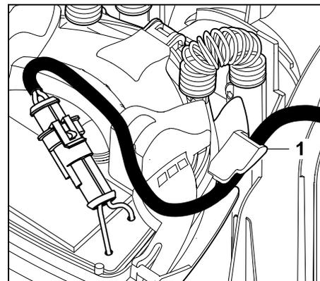
Inserire il cavo di alimentazione tramite la guida cavo (1) sul pannello.
