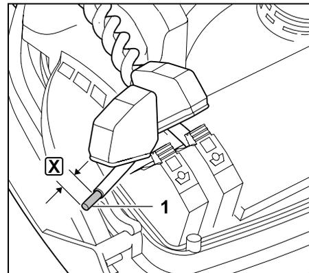
Strip het rechter draaduiteinde (1) met geschikt gereedschap op de aangegeven lengte **X** en draai de draden ineen.
