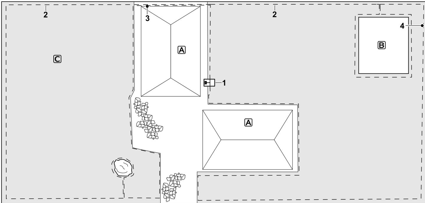
Gedeeld maaivlak – robotmaaier kan niet zelf van het ene naar het andere maaivlak rijden.
