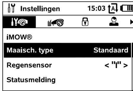
De submenu's "Instellingen" en "Informatie" worden als tabbladen weergegeven. Tabbladen worden geselecteerd door het stuurkruis naar links of naar rechts te drukken, submenu's door het stuurkruis omlaag of omhoog te drukken. Actieve tabbladen of menuopties zijn zwart gemarkeerd.
