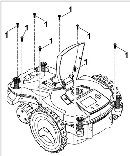
Schrauben (1) ausdrehen und entnehmen.
