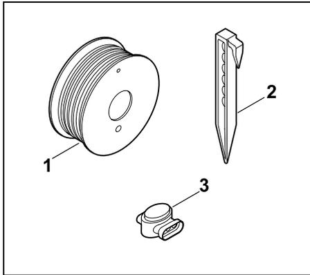
Die Installationskits enthalten Begrenzungsdraht auf Rolle (1) sowie Fixiernägel (2) und Drahtverbinder (3). Im Lieferumfang der Installationskits können noch zusätzliche Teile enthalten sein, die für die Installation nicht benötigt werden.
