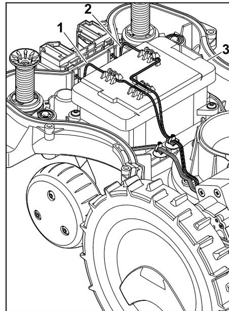
Neem kabel (1) en kabel (2) uit de kabelgeleidingen en verwijder de accu (3).
