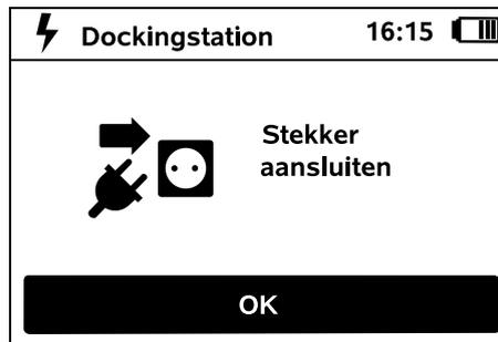
Sluit de stekker van de voeding aan op het elektriciteitsnet en druk daarna op de OK-toets. **OK**
