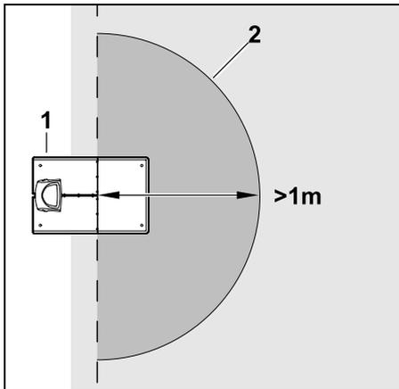
Devant la station de base (1), il doit y avoir un espace libre et plat (2) d'un rayon de 1 m minimum. Supprimer les monticules ou les creux.
