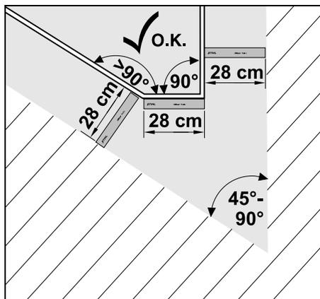
Negli angoli acuti del prato ( $45^\circ - 90^\circ$ ), fissare al terreno il filo perimetrale come indicato in figura. I due angoli devono avere una distanza di almeno **28 cm**, in modo tale che il robot tosaerba possa percorrere il bordo.
