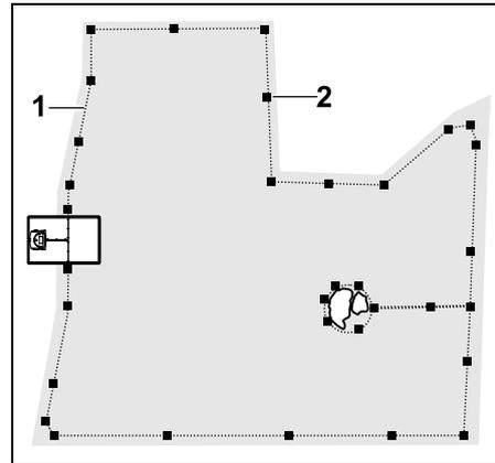
Poser le fil de délimitation (1) autour de la zone de tonte et d'éventuels obstacles (⇒ 12.9) et le fixer au sol avec des piquets de fixation (2). Contrôler les distances à l'aide de l'iMOW® Ruler. (⇒ 12.5)
