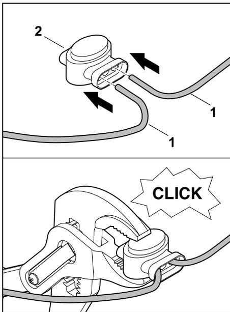
Lose, nicht abisolierte Drahtenden (1) bis zum Anschlag in Drahtverbinder (2) stecken. Drahtverbinder mit einer geeigneten Zange zusammendrücken – auf korrektes Einrasten achten.
