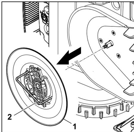
Soutenir l'appareil d'une main. Extraire le disque d'entraînement (1) en tirant sur l'extracteur (2).
