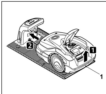
Sollevare leggermente il robot tosaerba utilizzando l'impugnatura per il trasporto (1) al fine di alleggerire il carico sulle ruote motrici. Spingere l'attrezzo appoggiato sulle ruote anteriori nella docking station.
