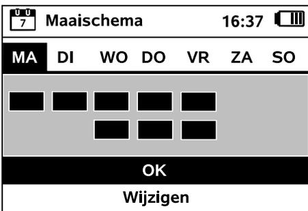
Met OK wordt het weergegeven maaischema bevestigd en de afsluitende stap van de installatiewizard verschijnt.
