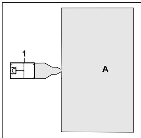
Het dockingstation (1) wordt buiten het maaivlak (A) geïnstalleerd.
