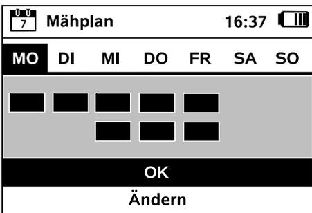
Mit OK wird der angezeigte Mähplan bestätigt und der abschließende Schritt des Installationsassistenten wird aufgerufen.
