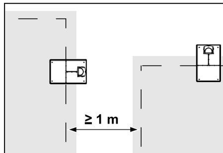
Maaivlakken mogen elkaar niet overlappen. Er moet een afstand van minimaal  $\geq 1\text{ m}$  tussen de begrenzingsdraden van twee maaivlakken worden aangehouden.
