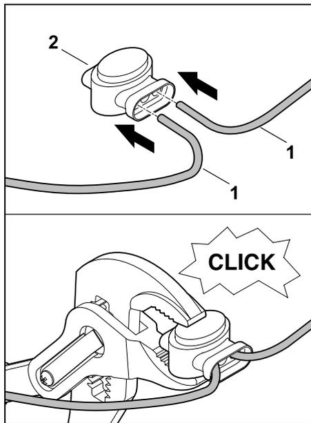
Collegare le estremità filo staccate, non spellate (1) fino alla battuta nella connessione filo (2). Comprimerne la connessione filo con un'apposita pinza, assicurandosi che l'innesto avvenga correttamente.
