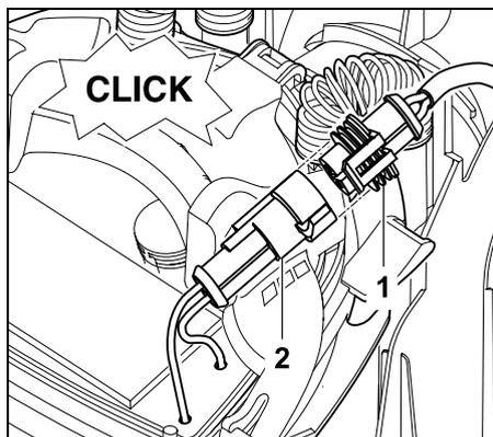
Sluit de stekker van de voeding (1) aan op de stekker van het dockingstation (2).
