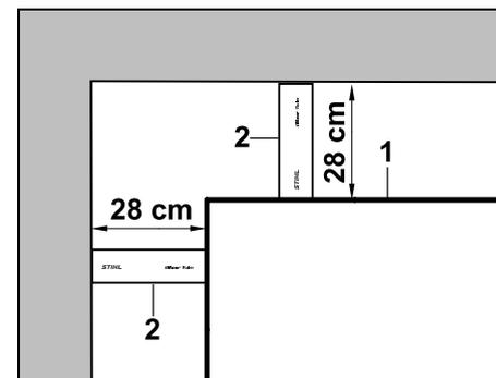
Lors de la pose du fil de délimitation (1) dans un coin intérieur au niveau d'un obstacle haut, mesurer la distance du fil avec l'iMOW® Ruler (2).
