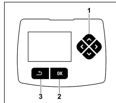
Vier Richtungstasten bilden das Steuerkreuz (1). Es dient zur Navigation in den Menüs, mit der OK-Taste (2) werden Einstellungen bestätigt und Menüs geöffnet. Mit der Zurück-Taste (3) können Menüs wieder verlassen werden.
