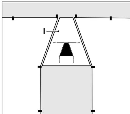
Per l'installazione della zona di accesso e uscita a forma di imbuto utilizzare anche la sagoma del passaggio fornita in dotazione (I).
