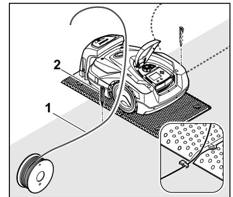
Bevestig de begrenzingsdraad (1) **links of rechts** naast de bodemplaat, direct naast een draaduitgang met een bevestigingspen (2) op de bodem.
