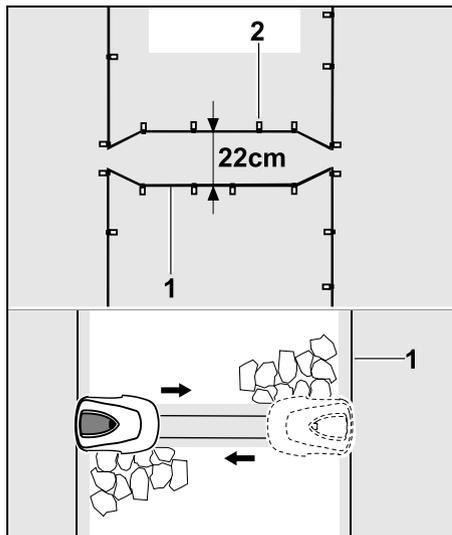
Dans les couloirs, le fil de délimitation (1) est posé parallèlement et fixé au sol avec un nombre suffisant de piquets de fixation (2). Au début et à la fin d'un couloir, il est nécessaire d'installer une entrée et une sortie en forme d'entonnoir.
