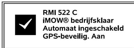
onderin het scherm worden de naam van de robotmaaier (⇒ 10.), de tekst "iMOW® bedrijfsklaar" samen met het afgebeelde symbool, de status van de automaat (⇒ 15.4) en informatie over de GPS-beveiliging (⇒ 5.9) weergegeven.
