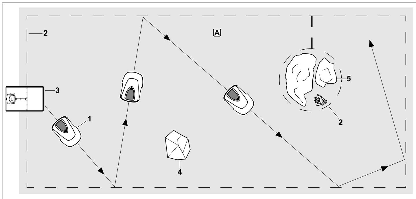
Il robot tosaerba (1) è stato progettato per il trattamento automatico di superfici prato. Il robot tosaerba taglia il prato a strisce disposte in ordine casuale.
