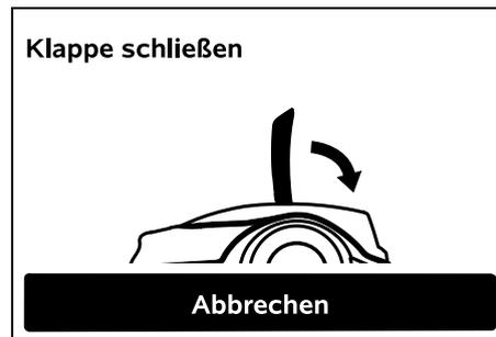
Die Klappe des Mähroboters schließen. (⇒ 15.2) Erst bei geschlossener Klappe startet der Mähroboter selbstständig und fährt entlang des Begrenzungsdraht den Rand ab.
