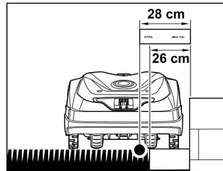
Leg de begrenzingsdraad op 28 cm afstand van de hindernis. Om ervoor te zorgen dat de rand van het gazon volledig wordt gemaaid, moeten de stenen ten minste 26 cm breed zijn. Als er bredere stenen worden gelegd, wordt de rand van het gazon nog preciezer gemaaid.
