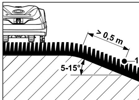
se nell'area taglio è presente una zona con una pendenza di 5° - 15°, è possibile disporre il filo perimetrale sulla superficie in pendenza al di sotto dei bordi del terreno, come mostrato in figura. Per fare in modo che il robot tosaerba possa funzionare senza problemi, è necessario rispettare la distanza minima (0,5 m) dai bordi del terreno al filo perimetrale.
