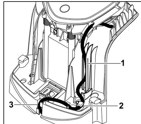
Enfoncer le câble électrique dans le guide-câble (1) et le guider dans le dispositif de maintien du câble (2) et la goulotte électrique (3) jusqu'au bloc d'alimentation.
