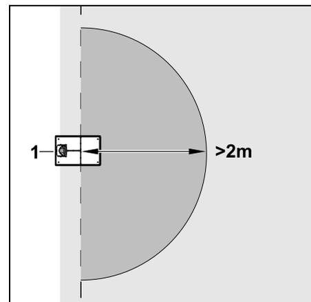
Pour ne pas perturber l'arrimage, aucun îlot de blocage ne doit être installé dans un rayon d'au moins **2 m** autour de la station de base (1).
