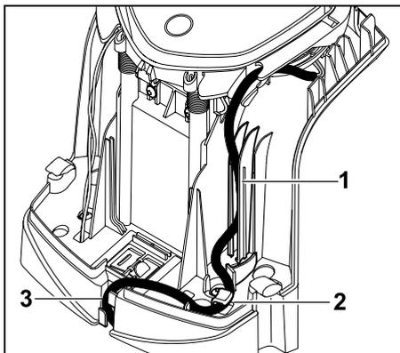
Inserire il cavo di alimentazione come indicato in figura nella guida cavo (1) e farlo passare attraverso la protezione antitrazione cavo (2) e la canalina per cavi (3) verso l'alimentatore.
