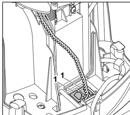
Chiudere le coperture della canalina per cavi (1).
