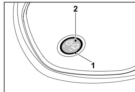
Eine ringförmige, rote LED (1) informiert über den Status der Dockingstation und des Drahtsignals.
