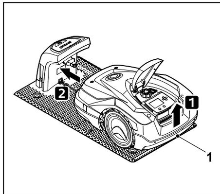
Soulever légèrement le robot de tonte par la poignée de transport (1) afin de décharger les roues motrices. Pousser l'appareil appuyé sur ses roues avant dans la station de base.
