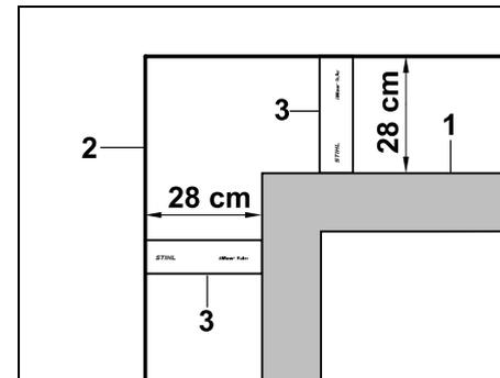
In caso di disposizione attorno a ostacoli alti, quali angoli di muro oppure aiuole alte (1), è necessario rispettare una distanza filo negli angoli così da evitare che il robot tosaerba strisci contro l'ostacolo stesso. Disporre il filo perimetrale (2) con l'ausilio di una dima distanziatrice iMOW® (3) come indicato in figura.
