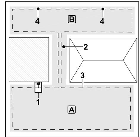
Die Dockingstation (1) wird in der Mähfläche **A** installiert. Die Mähfläche **B** ist mit einer Gasse (2) mit der Mähfläche **A** verbunden. Der Begrenzungsdraht (3) kann vom Mähroboter durchgängig befahren werden. Zum Bearbeiten der Mähfläche **B** sind Startpunkte (4) zu definieren. (⇒ 11.14) Einzelne Mähvorgänge werden dann je nach Einstellung (Starthäufigkeit) bei den Startpunkten begonnen.
