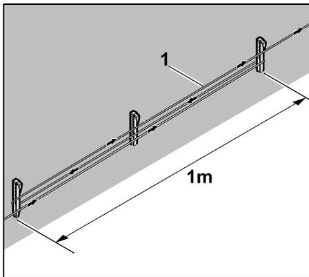
Poser le fil de délimitation (1) sur une longueur d'env. 1 m entre 2 piquets de fixation, comme indiqué sur la figure. Fixer la réserve de fil au sol en son centre, avec un autre piquet de fixation.
