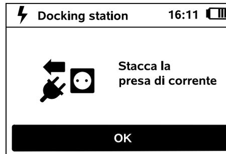
Staccare il connettore dell'alimentatore dall'alimentazione di corrente e premere il tasto OK.
