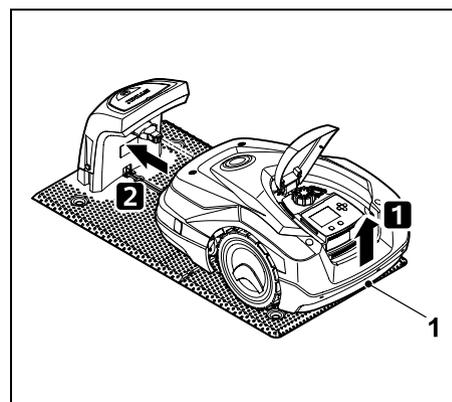
Sollevarlo leggermente il robot tosaerba utilizzando l'impugnatura per il trasporto (1) al fine di alleggerire il carico sulle ruote motrici. Spingere l'attrezzo appoggiato sulle ruote anteriori nella docking station.
