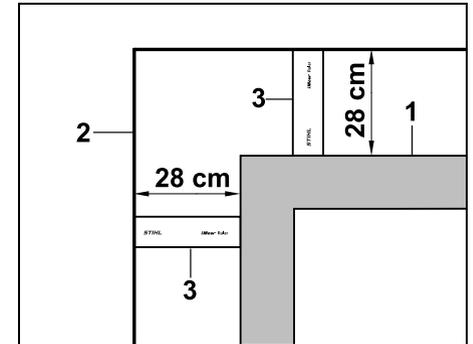
Lors de la pose autour d'obstacles hauts tels que des murs ou des plate-bandes (1), il faut respecter l'espacement de la bande dans les angles, afin que le robot de tonte n'effleure pas l'obstacle. Poser le fil de délimitation (2) à l'aide de l'iMOW® Ruler (3) comme indiqué sur la figure.
