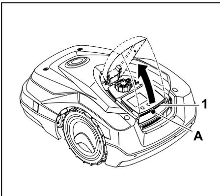
Klappe (1) am Haltepunkt (A) nehmen und durch einen leichten Ruck nach oben lösen. Klappe bis zum Anschlag öffnen.
