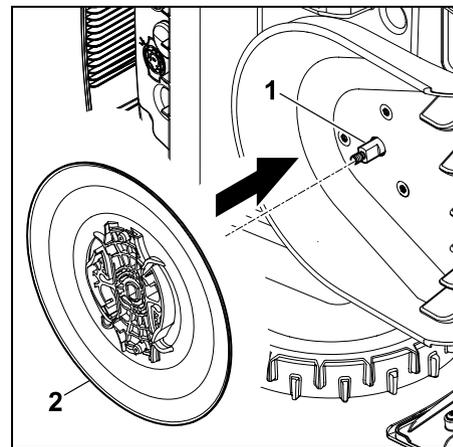
Nettoyer soigneusement l'arbre des lames (1) et le logement sur le disque d'entraînement (2). Enfoncer le disque d'entraînement sur l'arbre des lames jusqu'en butée.
