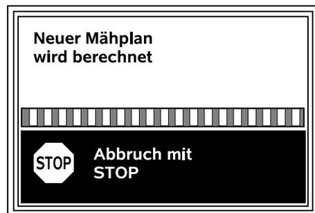
Ein neuer Mähplan wird berechnet. Mit der roten STOP-Taste auf der Geräteoberseite kann der Vorgang abgebrochen werden.
