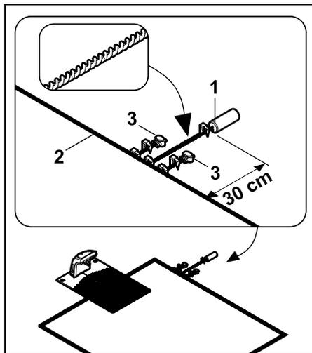
À l'aide d'un piquet de fixation, fixer l'AKM 100 (1) à une distance de 30 cm en dehors de la zone de tonte. Torsader les extrémités du fil jusqu'à la zone de tonte et les fixer à l'aide d'un piquet de fixation.
