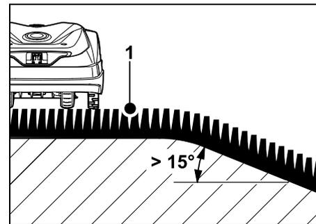
Si la zone de tonte présente une partie inclinée d'une déclivité  $> 15^\circ$  où un fil de délimitation doit être posé, il est recommandé de poser le fil de délimitation (1) dans la zone plane au-dessus du bord du terrain, comme indiqué sur la figure. Le bord du terrain et la partie en pente ne sont pas ton dus.
