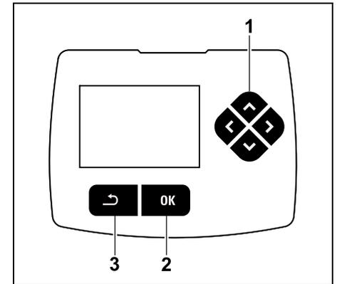
Das Steuerkreuz (1) dient zur Navigation in den Menüs, mit der OK-Taste (2) werden Einstellungen bestätigt und Menüs geöffnet. Mit der Zurück-Taste (3) können Menüs wieder verlassen werden.
