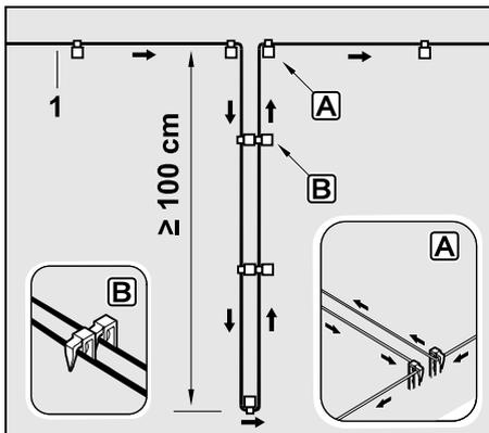
Installer la boucle de recherche dans la pelouse comme indiqué sur la figure. Le fil de délimitation (1) doit être fixé au sol au niveau du bord **A** à l'aide de deux piquets de fixation et ne doit pas se croiser.
