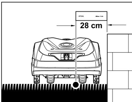
Der Mähroboter muss vollständig innerhalb der Mähfläche fahren und darf das Hindernis nicht berühren.
