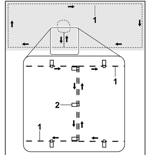
In Verbindungsstrecken wird der Begrenzungsdraht (1) parallel verlegt, die Drähte dürfen sich nicht überkreuzen und müssen eng beieinander liegen. Die Verbindungsstrecke mit einer ausreichenden Anzahl an Fixiernägeln (2) am Boden festmachen.
