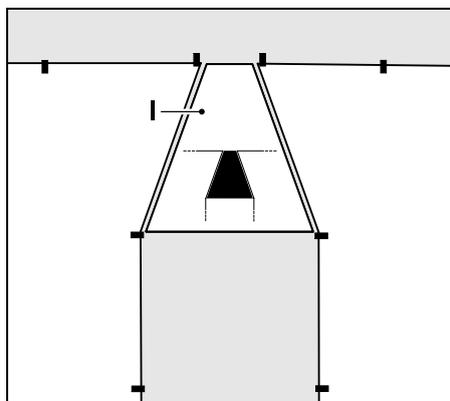
Utiliser le gabarit pour couloir (I) fourni pour installer l'entrée et la sortie en forme d'entonnoir.
