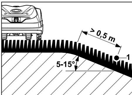
Als zich in het maaivlak een afhellend gedeelte met een verval van  $5^\circ - 15^\circ$  bevindt, kan de begrenzingsdraad zoals afgebeeld onder de rand van het terrein in het afhellende gedeelte worden gelegd. Voor een storingsvrije werking van de robotmaaier moet de minimumafstand (0,5 m) van de begrenzingsdraad tot de rand van het terrein worden aangehouden.
