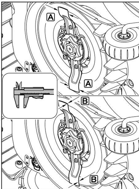
Controllare la **larghezza lama** **A** e lo **spessore lama** **B** con un calibro. Se in un punto la lama fosse più sottile di **25 mm** oppure se lo spessore fosse inferiore a **1,3 mm**, è necessario sostituirla.
