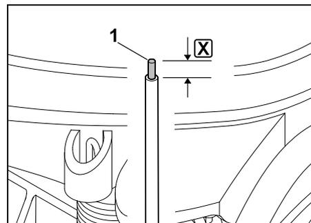
À l'aide d'un outil adéquat, dénuder l'extrémité de fil gauche (1) sur la longueur indiquée **X** et torsader le toron.
