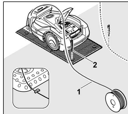
Fissare il filo perimetrale (1) al terreno a **sinistra** oppure a **destra** dietro alla piastra di fondo, direttamente accanto all'uscita filo servendosi di un elemento di ancoraggio (2).
