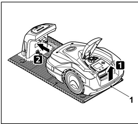
e il carico sulle ruote motrici, sollevare leggermente il robot tosaerba dall'impugnatura per il trasporto (1). Spingere l'attrezzo appoggiato sulle ruote anteriori nella docking station.
