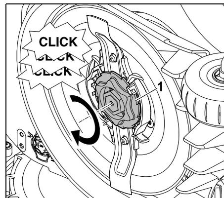
Schroef de borgmoer (1) tot aan de aanslag erop. Tijdens het vastdraaien klinken er meerdere klikgeluiden. Controleer of het maaimes goed vast zit door voorzichtig eraan te schudden.
