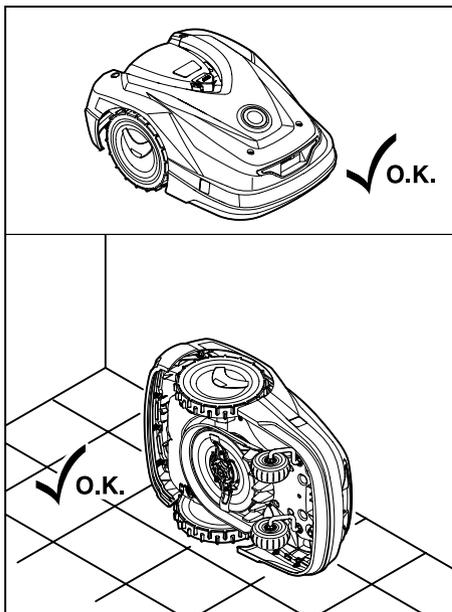
Pour nettoyer la **partie supérieure de l'appareil** (capot, volet), placer l'appareil sur une surface plane, ferme et horizontale. Pour nettoyer le **dessous de l'appareil** (lame de coupe, plateau de coupe), incliner le robot de tonte sur son côté gauche ou droit et l'appuyer contre un mur, comme indiqué sur la figure.
