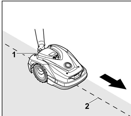
Mit dem Mähroboter ausgehend von der Dockingstation den Rand der Mähfläche **im Uhrzeigersinn** abfahren. Dazu Gerät am Tragegriff hinten (1) etwas anheben, um die Antriebsräder zu entlasten. Mit dem auf die Vorderräder aufgestützten Mähroboter dem Begrenzungsdraht (2) folgen. Es ist darauf zu achten, dass der Begrenzungsdraht (2) unter den Drahtsensoren verläuft. Die Drahtsensoren sind geschützt links und rechts im vorderen Bereich des Mähroboters montiert.
