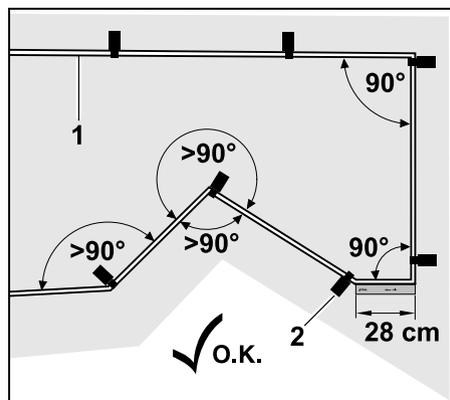
La disposizione in angoli acuti (inferiori a 90°) va evitata. Negli angoli acuti del prato, fissare il filo perimetrale (1) al terreno con elementi di ancoraggio (2). (⇒ 12.6)
