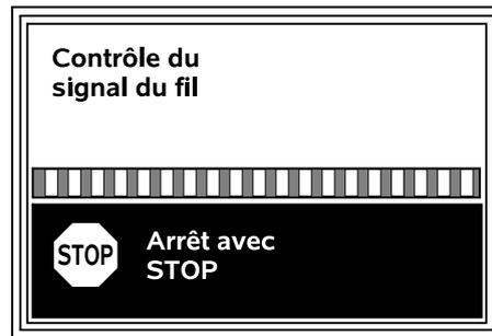
Le contrôle du signal du fil peut prendre plusieurs minutes. La connexion est annulée lorsque l'utilisateur appuie sur la touche rouge STOP située sur la partie supérieure de l'appareil ; l'étape précédente de l'assistant d'installation s'affiche alors.
