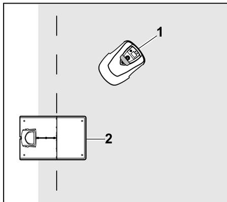
Mähroboter (1) wie abgebildet hinter der Dockingstation (2) innerhalb der Mähfläche abstellen, anschließend OK-Taste drücken.
