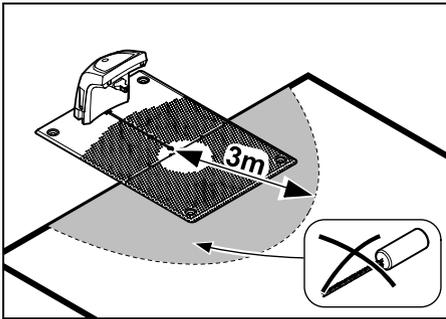
Installeer de AKM 100 op een minimumafstand van 3 m van het dockingstation.
