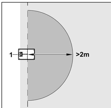
Damit das Eindocken nicht gestört wird, darf im Umkreis von mindestens **2 m** um die Dockingstation (1) keine Sperrfläche installiert werden.
