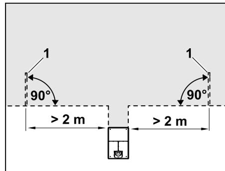
À gauche et à droite de l'accès à la station de base externe, deux boucles de recherche (1) doivent être installées à un angle de 90° par rapport au fil de délimitation.
