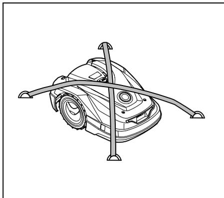
Zet de robotmaaier op het laadoppervlak vast. Zet het apparaat daarvoor zoals afgebeeld met geschikte bevestigingsmiddelen (gordels, kabels) vast.
