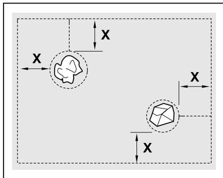
Le superfici di sbarramento devono avere un **diametro minimo** di 56 cm. La **distanza rispetto al circuito perimetrale (X)** deve essere superiore a 44 cm.
