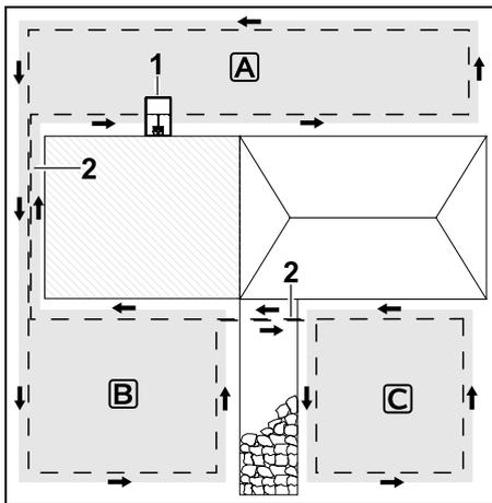
La docking station (1) viene installata nell'area taglio **A** e tale area viene trattata in modo completamente automatico secondo lo schema di taglio erba. Le superfici secondarie **B** e **C** sono collegate tramite dei tratti di collegamento (2) all'area taglio **A**. Su tutte le superfici il filo perimetrale deve essere disposto nella stessa direzione – Non incrociare mai il filo perimetrale nei tratti di collegamento.
