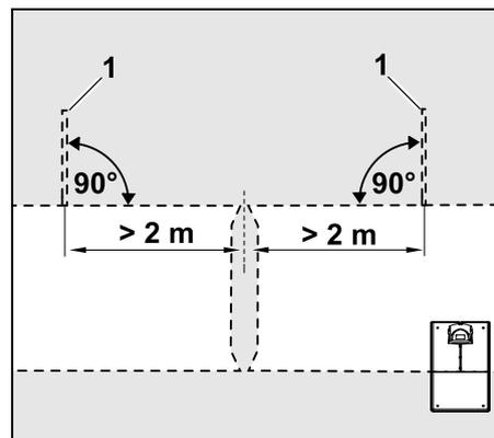
À gauche et à droite de l'entrée du couloir, deux boucles de recherche (1) doivent être installées à un angle de 90° par rapport au fil de délimitation et ce, toujours dans la partie de la zone de tonte qui ne peut être atteinte que par un couloir. Distance minimale par rapport à l'entrée du couloir : 2 m
