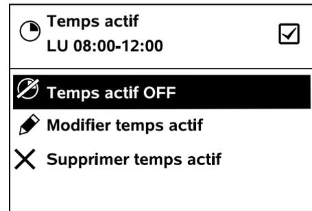
L'option **Temps actif OFF** ou **Temps actif ON** permet de bloquer ou de débloquer le temps actif sélectionné pour la tonte automatique.
