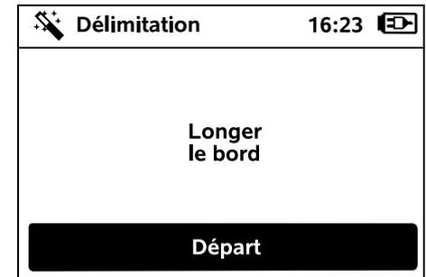
Démarrer le déplacement le long du bord en appuyant sur la touche OK – la lame de coupe ne doit alors pas être activée.
