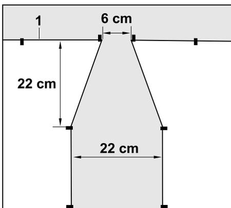
Au début et à la fin d'un couloir, le fil de délimitation (1) doit être posé en forme d'entonnoir, comme indiqué sur la figure. On évite ainsi que le robot de tonte roule involontairement dans le couloir lors de la tonte.
