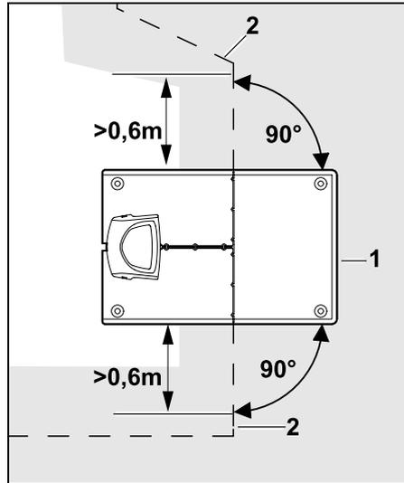
Vor und nach der Dockingstation (1) Begrenzungsdraht (2) **0,6 m** geradeaus und im rechten Winkel zur Bodenplatte verlegen. Danach mit dem Begrenzungsdraht dem Rand der Mähfläche folgen.
