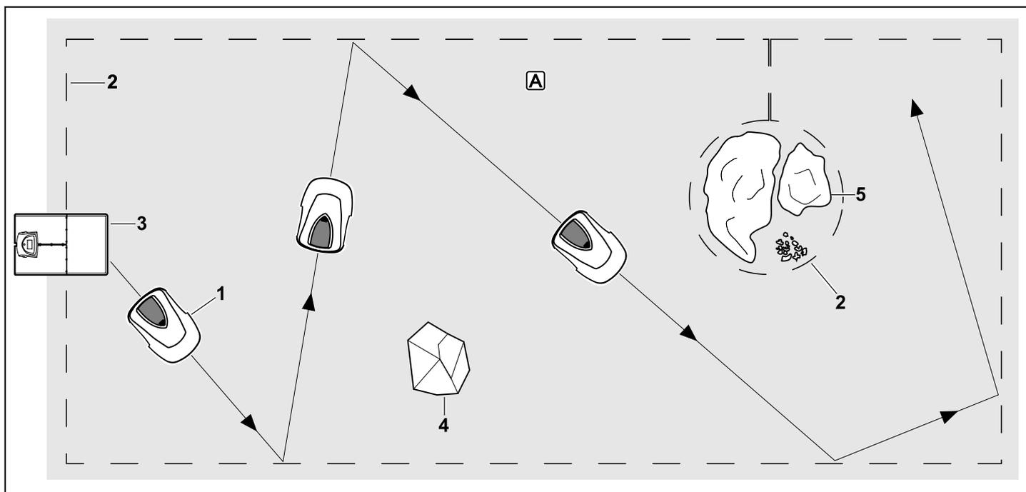
De robotmaaier (1) is ontwikkeld voor het automatisch onderhouden van gazons. Hij maait het gazon in willekeurig gekozen banen.
