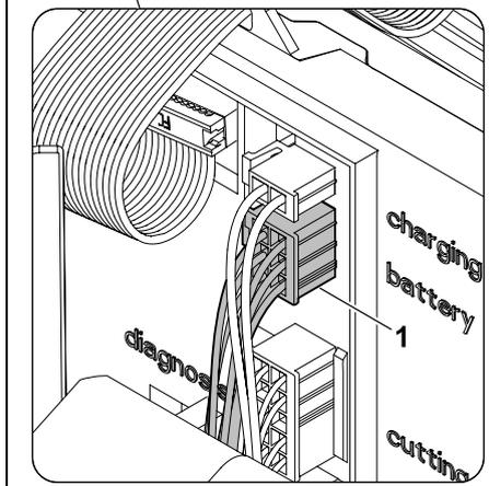
Débrancher le connecteur (1) (battery).
