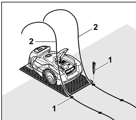
Enfoncer le dernier piquet de fixation (1) à gauche ou à droite derrière la plaque de base, directement à côté de la sortie de fil. Couper le fil de délimitation (2) sur une longueur libre d'env. 2 m.
