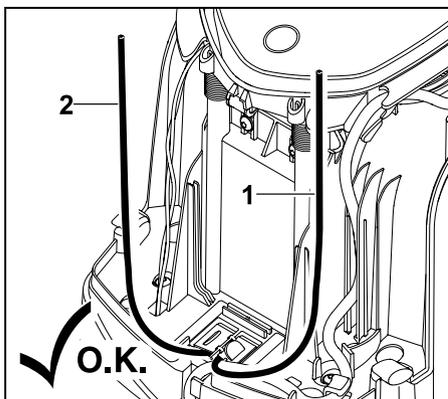
Raccourcir l'extrémité de fil gauche (1) et l'extrémité de fil droite (2) à la même longueur. Longueur de la sortie de fil à l'extrémité de fil : **40 cm**
