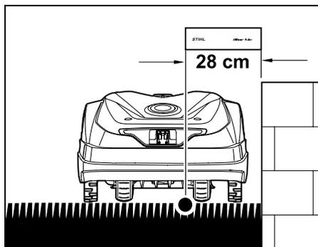
Le robot de tonte doit rouler entièrement à l'intérieur de la zone de tonte et ne doit pas toucher l'obstacle.
