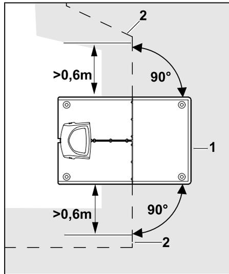
Poser le fil de délimitation (2) devant et derrière la station de base (1) sur une ligne droite de **0,6 m** et à angle droit par rapport à la plaque de base. Longez ensuite le bord de la zone de tonte avec le fil de délimitation.
