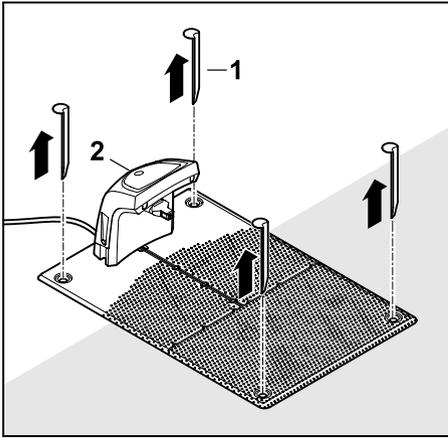
Heringe (1) herausziehen, Dockingstation (2) mit dem angeschlossenen Netzteil aus der Rasenfläche entfernen, gründlich reinigen (mit einem feuchten Tuch) und einlagern.
