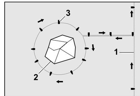
Stendere il filo perimetrale (1) dal bordo all'ostacolo, disporlo a una distanza corretta attorno all'ostacolo (2) e fissarlo al terreno con un numero sufficiente di elementi di ancoraggio (3). Infine, riportare il filo perimetrale verso il bordo.
