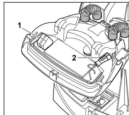
Con il pannello chiuso, i collegamenti del filo perimetrale (1) e il cavo di alimentazione (2) sono protetti dalle intemperie.
