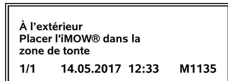
Les erreurs, les anomalies ou recommandations sont affichées avec un symbole d'avertissement, la date, l'heure et un code de message. Si plusieurs messages sont actifs, ils apparaissent en alternance. (⇒ 24.)
