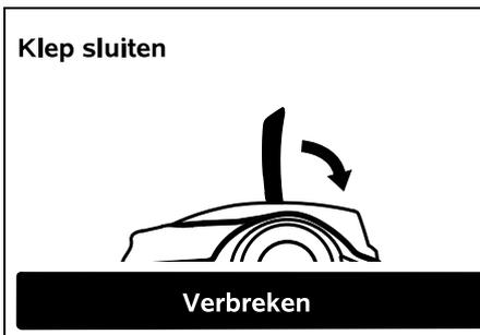
Sluit de klep van de robotmaaier. (⇒ 15.2)
