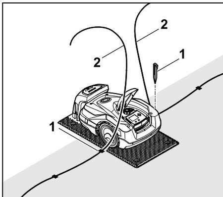
Enfoncer le dernier piquet de fixation (1) à gauche ou à droite de la plaque de base, directement à côté de la sortie de fil. Couper le fil de délimitation (2) sur une longueur libre d'env. 1,5 m.
