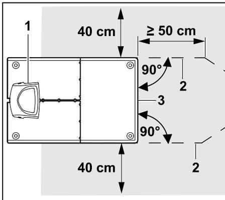
Poser le fil de délimitation (2) devant et derrière la station de base (1) à une distance de 50 cm et à angle droit par rapport à la plaque de base. Il est possible ensuite d'installer un couloir (⇒ 12.11) ou de suivre le bord de la zone de tonte avec le fil de délimitation.
