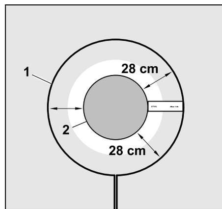
Le robot de tonte contourne l'obstacle (2) sans le heurter en suivant le fil de délimitation (1).
