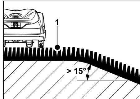
Befindet sich in der Mähfläche ein abfallender Bereich mit einem Gefälle  $> 15^\circ$ , in der ein Begrenzungsdraht verlegt werden soll, wird empfohlen, den Begrenzungsdraht (1) wie abgebildet in der ebenen Fläche oberhalb der Geländekante zu verlegen. Die Geländekante und der abfallende Bereich werden nicht gemäht.
