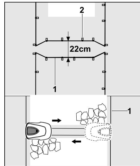
Nei passaggi il filo perimetrale (1) viene disposto in parallelo e fissato al terreno con un numero sufficiente di elementi di ancoraggio (2). All'inizio e alla fine del passaggio è necessario installare una zona di accesso e di uscita a forma di imbuto.
