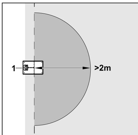
Affinché l'inserimento in stazione non venga disturbato, le superfici di sbarramento devono essere installate mantenendo un raggio di almeno **2 m** attorno alla docking station (1).
