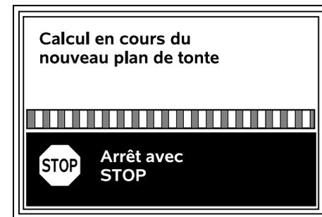
Un nouveau plan de tonte est calculé. Il est possible d'annuler le processus en appuyant sur la touche STOP rouge située sur le dessus de l'appareil.
