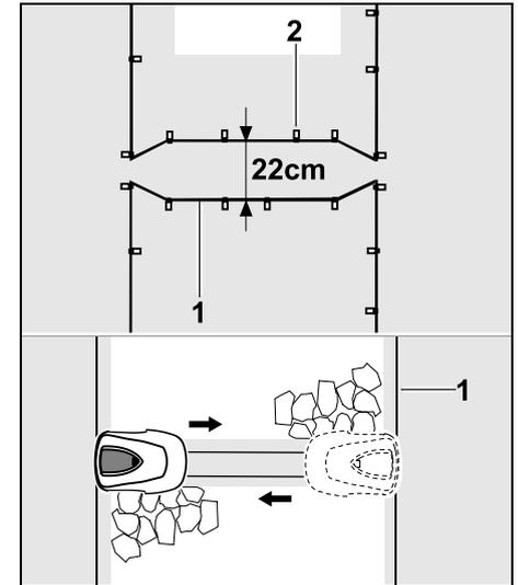
In Gassen wird der Begrenzungsdraht (1) parallel verlegt und mit einer ausreichenden Anzahl an Fixiernägeln (2) am Boden festgemacht. Am Anfang und am Ende der Gasse sollte eine trichterförmige Ein- und Ausfahrt mit installiert werden.
