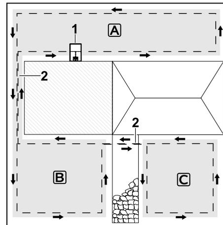
Het dockingstation (1) wordt in het maaivlak **A** geïnstalleerd; dit wordt volgens het maaischema volautomatisch bewerkt.
