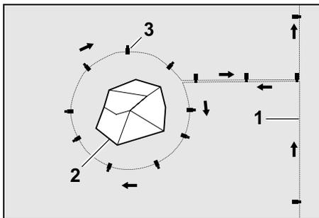
Guider le fil de délimitation (1) de la bordure jusqu'à l'obstacle, le poser autour de l'obstacle (2) à une distance correcte et le fixer au sol avec un nombre suffisant de piquets de fixation (3). Ensuite, poser le fil de délimitation de nouveau le long du bord.
