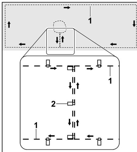
In verbindingstrajecten wordt de begrenzingsdraad (1) parallel gelegd, de draden mogen elkaar niet kruisen en moeten dicht bij elkaar liggen. Maak het verbindingstraject met voldoende bevestigingspennen (2) aan de bodem vast.
