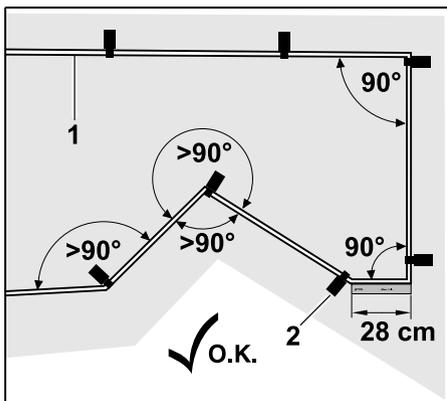
Leg de draad bij voorkeur niet in scherpe hoeken (kleiner dan 90°). Leg in de spits toelopende hoeken van het gazon de begrenzingsdraad (1) zoals afgebeeld en zet deze met bevestigingspennen (2) vast op de grond. (⇒ 12.6)
