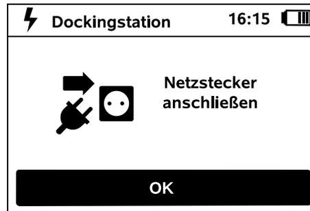
Stecker des Netzteils an Stromnetz anschließen, anschließend OK-Taste drücken.
