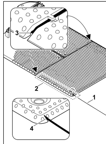
Poser le fil de délimitation (1) dans la zone (2) sous la plaque de base. À cet effet, faire passer le fil dans les sorties de fil (3, 4) ; desserrer des baïonnettes si nécessaire.
