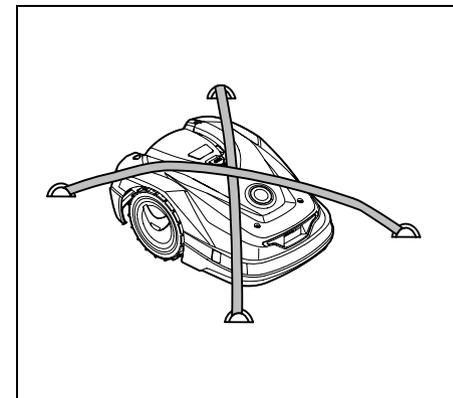
Fissare il robot tosaerba sulla superficie di carico. A tale scopo fissare l'attrezzo come indicato in figura con l'ausilio di appositi dispositivi di fissaggio (cinghie, corde).
