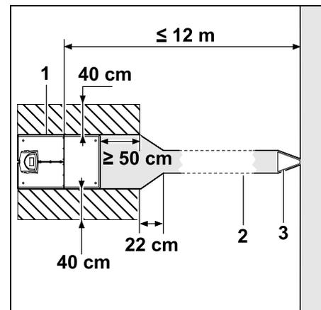
Affinché l'entrata e l'uscita dalla docking station avvengano correttamente, la docking station (1) può essere installata con un passaggio (2), come mostrato in figura. Le zone attorno alla docking station e all'esterno del filo perimetrale devono essere piane e liberamente percorribili. Eliminare eventuali avvallamenti e collinette.
