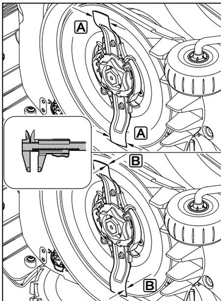
Vérifier la **largeur de la lame A** et l'**épaisseur de la lame B** à l'aide d'un pied à coulisse.
