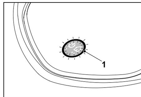
Una volta che il filo perimetrale è montato correttamente e la docking station è collegata alla rete elettrica, il LED (1) si accende.
