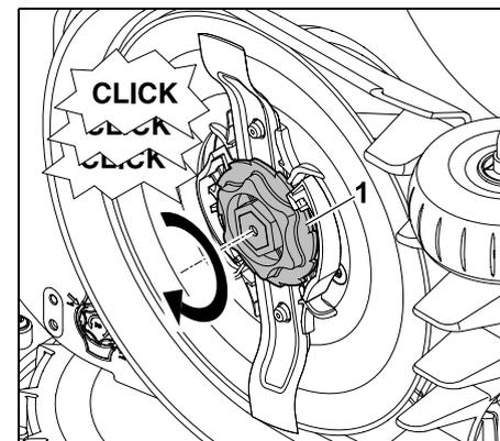
Visser l'écrou de fixation (1) jusqu'en butée. Plusieurs bruits de clic sont audibles pendant le serrage. Contrôler la bonne fixation de la lame de coupe en la secouant avec précaution.
