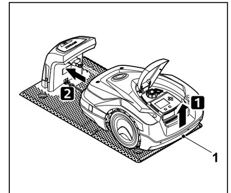
Til de robotmaaier aan de handgreep (1) iets op om de aandrijfwielen te ontlasten. Schuif het apparaat op de voorwielen in het dockingstation.
