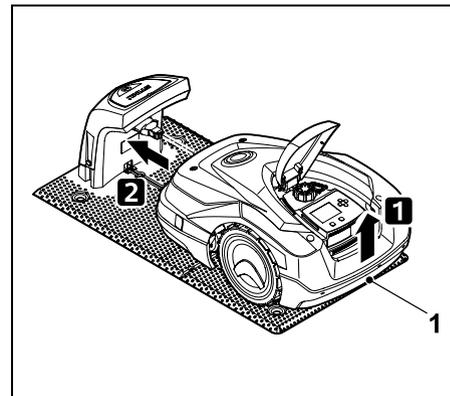
Til de robotmaaier aan de handgreep (1) iets op om de aandrijfwielen te ontlasten. Schuif het apparaat op de voorwielen in het dockingstation.
