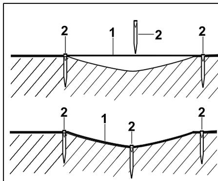
Il filo perimetrale (1) viene disposto sopra terra e fissato con elementi di ancoraggio aggiuntivi (2) in presenza di irregolarità. Ciò impedisce che il filo venga tagliato dalla lama del tosaerba.
