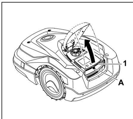
Saisir le volet (1) au niveau du point d'appui (A) et le dégager en exerçant une légère secousse vers le haut. Ouvrir le volet jusqu'en butée.
