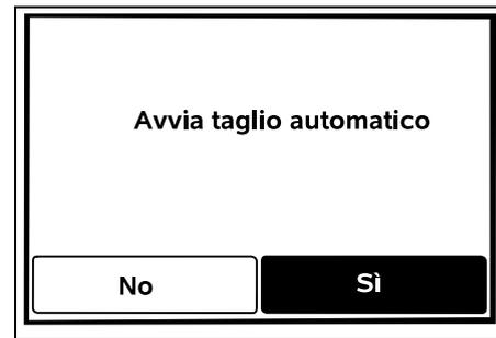
Se il completamento dell'installazione iniziale avvenisse al di fuori dell'orario attivo, premendo il tasto OK si avvia un'azione di taglio. Se non si desidera che il robot tosaerba tagli, selezionare "No".
