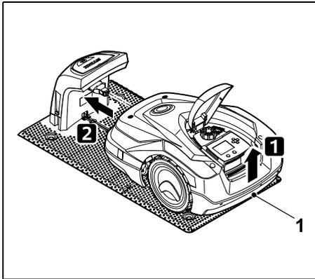
Tragegriff (1) etwas anheben, um die Antriebsräder zu entlasten. Gerät auf die Vorderräder aufgestützt in die Dockingstation schieben.
