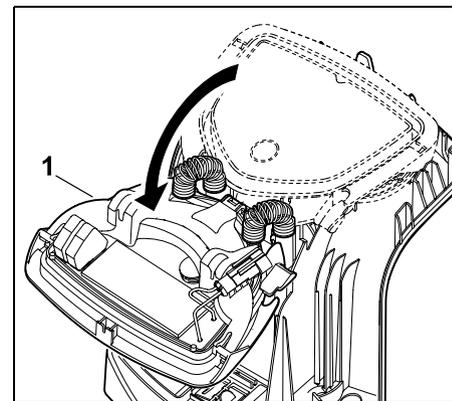
Aprire il pannello (1) portandolo in avanti. Trattenere il pannello in posizione aperta poiché per via delle molle della cerniera si chiude automaticamente.
