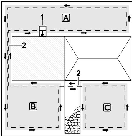
Die Dockingstation (1) wird in der Mähfläche **A** installiert, diese wird nach Mähplan vollautomatisch bearbeitet. Die Nebenflächen **B** und **C** sind mit Verbindungsstrecken (2) mit der Mähfläche **A** verbunden. In allen Flächen muss der Begrenzungsdraht in derselben Richtung verlegt werden – Begrenzungsdraht in den Verbindungstrecken nicht überkreuzen.
