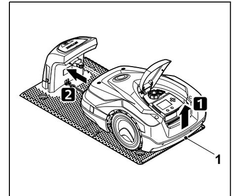
Mähroboter am Tragegriff (1) etwas anheben, um die Antriebsräder zu entlasten. Gerät auf die Vorderräder aufgestützt in die Dockingstation schieben.
