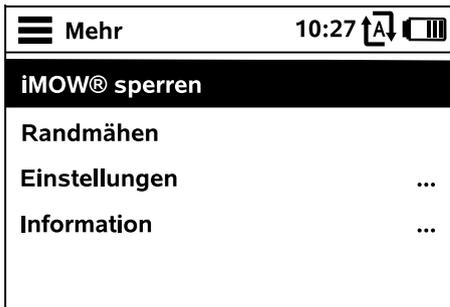
Die zweite Menüebene wird als Liste dargestellt. Untermenüs werden durch Drücken des Steuerkreuzes nach unten bzw. oben ausgewählt. Aktive Menüeinträge sind schwarz hinterlegt.
