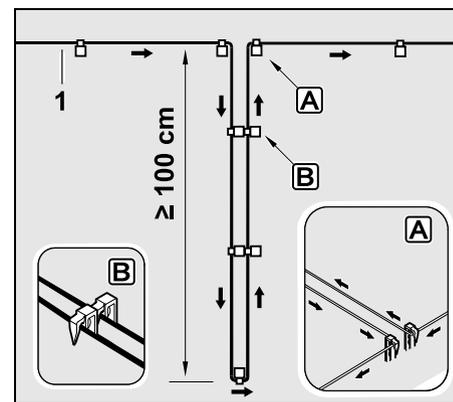
Installare il circuito guida all'interno della superficie del prato, come illustrato. Il filo perimetrale (1) deve essere fissato al bordo **A** con due elementi di ancoraggio al terreno e non deve essere sovrapposto. Lunghezza minima: **100 cm**
