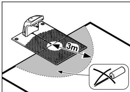
Installare l'AKM 100 a una distanza minima di 3 m dalla docking station.
