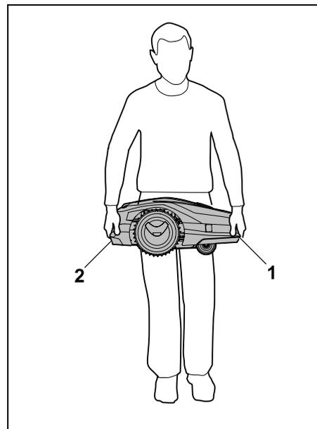
Sollevarlo e trasportarlo utilizzando l'impugnatura per il trasporto anteriore (1) e posteriore (2). Assicurarsi che la lama sia sempre rivolta in direzione opposta rispetto al corpo e che la distanza tra la lama e il corpo, in particolare i piedi e le gambe, sia adeguata.
