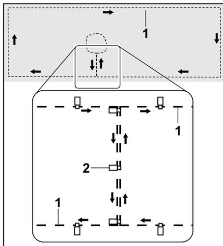
Dans les sections de liaison, le fil de délimitation (1) est posé bien parallèlement, les fils ne doivent pas se croiser et doivent être très près l'un de l'autre. Fixer la section de liaison au sol avec un nombre suffisant de piquets de fixation (2).
