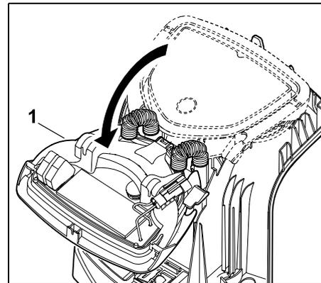
Klap het paneel (1) naar voren open. Houd het paneel in opengeklapte positie, omdat het vanwege de scharnieren vanzelf dichtklapt.
