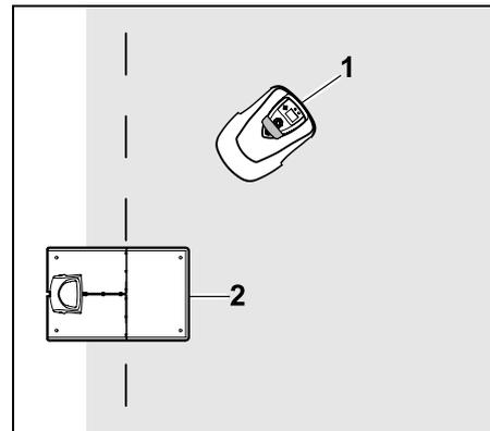
Déposer le robot de tonte (1) derrière la station de base, comme dans l'illustration, (2) dans la zone de tonte, puis appuyer sur la touche OK.
