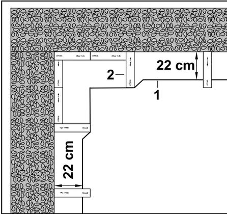
Poser le fil de délimitation (1) dans l'angle intérieur comme indiqué sur la figure. Utiliser l'iMOW® Ruler (2).
