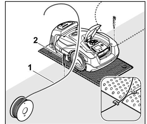
Begrenzungsdraht (1) **links** oder **rechts** neben der Bodenplatte, direkt neben einem Drahtauslass mit einem Fixiernagel (2) am Boden befestigen.
