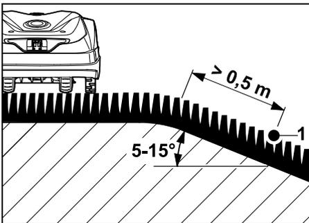
Befindet sich in der Mähfläche ein abfallender Bereich mit einem Gefälle von  $5^\circ - 15^\circ$ , kann der Begrenzungsdraht wie
