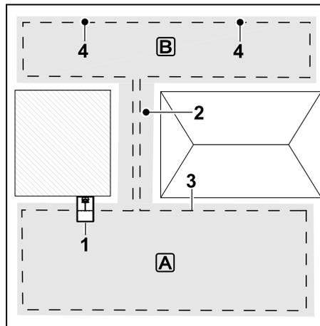
Het dockingstation (1) wordt in het maaivlak **A** geïnstalleerd. Het maaivlak **B** is met een doorgang (2) met het maaivlak **A** verbonden. De begrenzingsdraad (3) kan door de robotmaaier geheel worden afgereden. Voor het bewerken van het maaivlak **B** moeten startpunten (4) worden gedefinieerd. (⇒ 11.14) Afzonderlijke maaibeurten beginnen dan afhankelijk van de instelling (startfrequentie) bij de startpunten.
