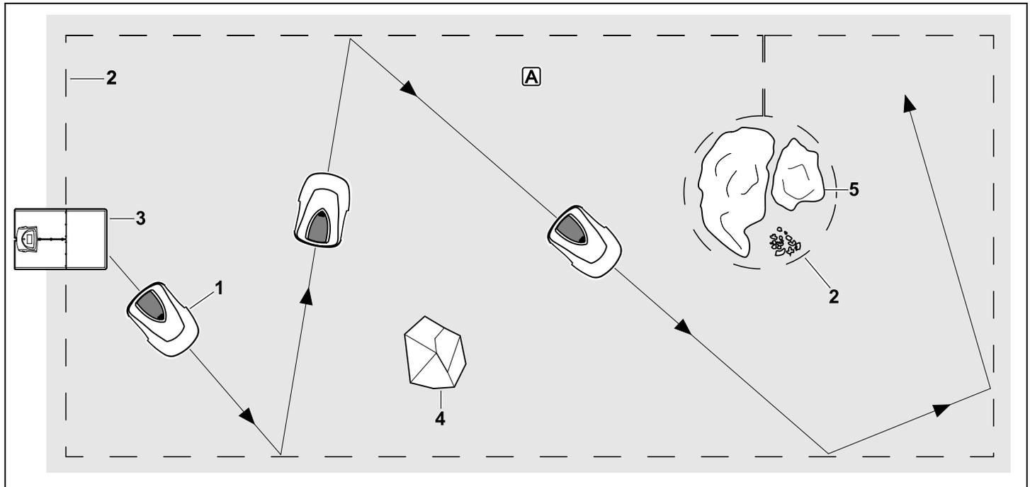
Der Mähroboter (1) ist für die automatische Bearbeitung von Rasenflächen konzipiert. Er mäht den Rasen in zufällig gewählten Bahnen.
