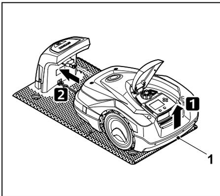
ement le robot de tonte par la poignée de transport (1) afin de délester les roues motrices. Pousser l'appareil appuyé sur ses roues avant dans la station de base.
