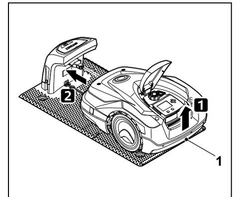
aaier aan de handgreep (1) iets op om de aandrijfwielen te ontlasten. Schuif het apparaat op de voorwielen in het dockingstation.
