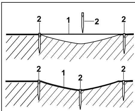
De begrenzingsdraad (1) wordt op de grond gelegd en bij oneffenheden met extra bevestigingspennen (2) vastgezet. Op deze manier wordt voorkomen dat de draad door het maaimes wordt doorgesneden.
