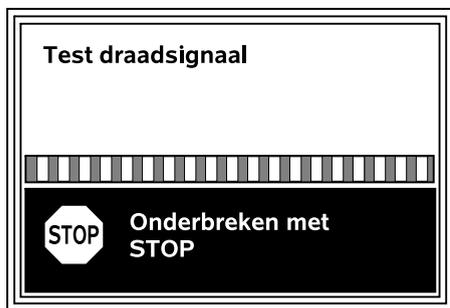
De test van het draadsignaal kan meerdere minuten duren. Met de rode STOP-toets op de bovenkant van het apparaat wordt het koppelen afgebroken, waarna de vorige stap van de installatiewizard verschijnt.
