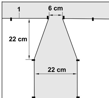
All'inizio e alla fine di un passaggio è necessario disporre il filo perimetrale (1) a forma di imbuto, come mostrato in figura. In tal modo si evita che il robot tosaerba percorra accidentalmente il passaggio durante l'azione di taglio.
