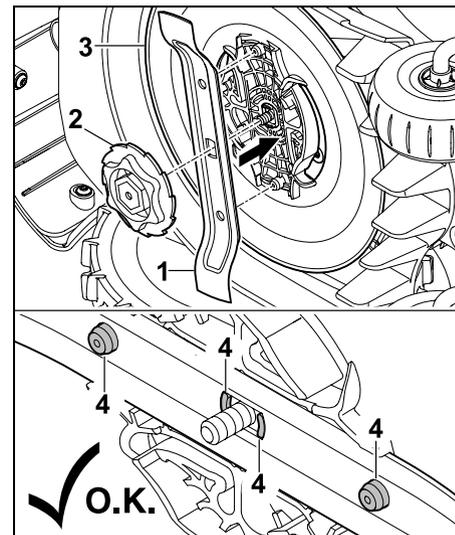
Posizionare la lama (1) e il dado di fissaggio (2) sul disco trascinatore (3) come indicato in figura. Fare attenzione che i naselli di fissaggio (4) nella lama siano posizionati correttamente.
