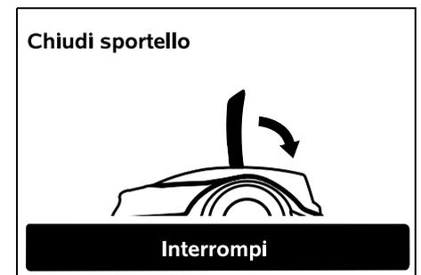
Chiudere lo sportello del robot tosaerba. (⇒ 15.2) Solamente quando lo sportello è chiuso, il robot tosaerba si avvia automaticamente e percorre il bordo lungo il filo perimetrale.
