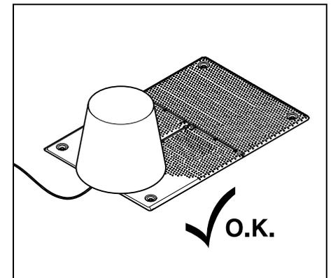
Dockingstation mit einem geeigneten Eimer abdecken, Eimer fixieren.
