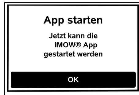
Damit alle Funktionen des Mähroboters genutzt werden können, muss die **iMOW® App** auf einem Smartphone bzw. Tablet-Computer mit Internet-Verbindung und GPS-Empfänger installiert und gestartet werden. (⇒ 10.)
