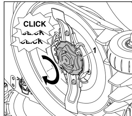
Fixiermutter (1) bis zum Anschlag aufschrauben. Während des Festziehens sind mehrere Click-Geräusche hörbar. Den sicheren Sitz des Mähmessers durch vorsichtiges Rütteln kontrollieren.
