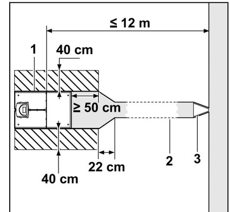
Pour que l'arrimage et la sortie fonctionnent correctement, il est possible d'installer la station de base (1) avec un couloir (2), comme indiqué sur la figure. Les zones autour de la station de base et à l'extérieur du fil de délimitation doivent être planes et dégagées. Supprimer les monticules ou les creux.
