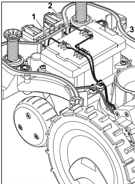
Rimuovere il cavo (1) e il cavo (2) dalle guide cavo e togliere la batteria (3).
