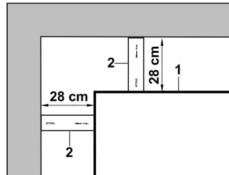
Durante la disposizione del filo perimetrale (1) nell'angolo interno di un ostacolo alto, misurare la distanza filo con la dima distanziatrice iMOW® (2).
