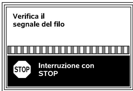
La verifica del segnale filo può durare alcuni minuti. Mediante il tasto STOP rosso sulla parte superiore dell'attrezzo si interrompe il collegamento e viene richiamato il punto precedente dell'assistente di installazione.
