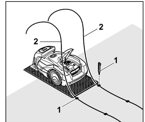
Den letzten Fixiernagel (1) links bzw. rechts hinter der Bodenplatte, direkt neben dem Drahtauslass einschlagen.
