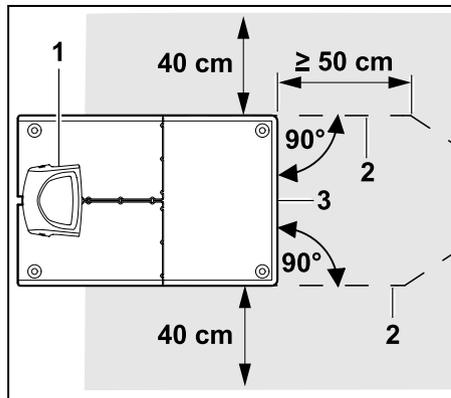
A monte e a valle della docking station (1) disporre il filo perimetrale (2) a una distanza di 50 cm ad angolo retto rispetto alla piastra di fondo. Successivamente è possibile installare un passaggio (⇒ 12.11) oppure seguire il bordo della superficie di taglio dell'erba con il filo perimetrale.
