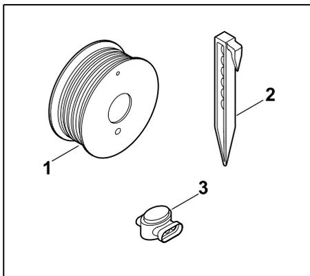
De installatiekits bevatten begrenzingsdraad op een rol (1), bevestigingspennen (2) en draadverbinder (3). In de installatiekits kunnen nog andere onderdelen zitten die voor de installatie niet nodig zijn.
