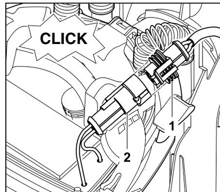
Inserire il connettore dell'alimentatore (1) nella presa all'interno della docking station (2).
