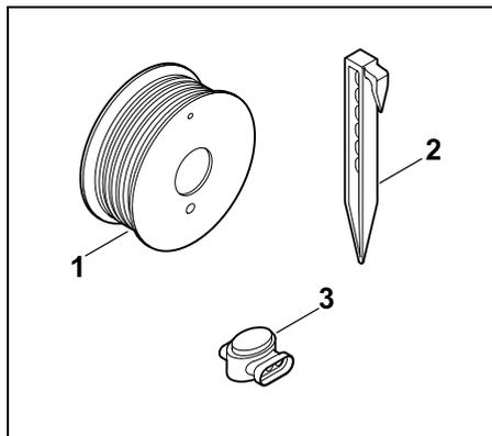
I kit di installazione contengono filo perimetrale su rullo (1) nonché elementi di ancoraggio (2) e connessione filo (3). Nella fornitura dei kit di installazione è possibile che siano contenuti ulteriori particolari non necessari all'installazione.
