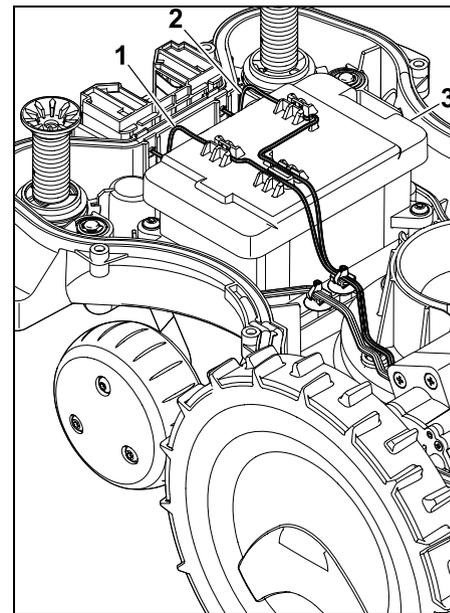
Retirer les câbles (1) et (2) des guide-câbles et enlever la batterie (3).
