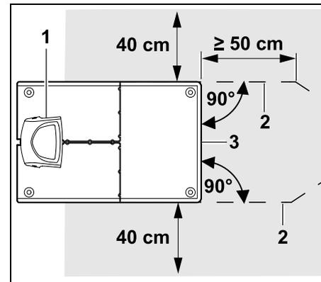
Leg **vóór** en achter het dockingstation (1) begrenzingsdraad (2) met een afstand van 50 cm in een rechte hoek ten opzichte van de bodemplaat. Vervolgens kan er een doorgang worden geïnstalleerd (⇒ 12.11) of kan met de begrenzingsdraad de rand van het maaivlak worden gevolgd.
