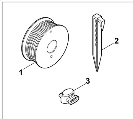
Les kits d'installation contiennent une bobine de fil de délimitation (1), ainsi que des piquets de fixation (2) et des connecteurs de fil (3). Des pièces supplémentaires qui ne sont pas nécessaires à l'installation peuvent également se trouver dans les kits d'installation.
