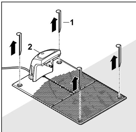
Estrarre i picchetti (1), rimuovere la docking station (2) con l'alimentatore collegato dalla superficie del prato, pulire accuratamente (con un panno umido) e riporre l'attrezzo.
