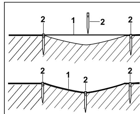
Le fil de délimitation (1) est posé au-dessus du sol et fixé avec des piquets de fixation (2) supplémentaires si le sol est irrégulier. Cela évite que le fil soit sectionné par la lame de coupe.
