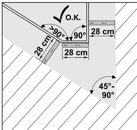
Aux coins pointus de la pelouse (45° - 90°), le fil de délimitation se pose comme indiqué sur la figure. Les deux angles doivent avoir un écart d'au moins **28 cm** afin que le robot de tonte puisse longer le bord.
