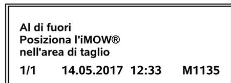
errori, anomalie e suggerimenti vengono visualizzati insieme a un simbolo di avvertenza, alla data, all'ora e al codice del messaggio. Se sono attivi diversi messaggi, vengono visualizzati in modo alternato. (⇒ 24.)
