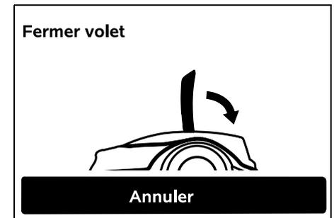
Fermer le volet du robot de tonte. (⇒ 15.2) Ce n'est qu'une fois que le volet est fermé que le robot de tonte démarre de manière autonome et suit le bord le long du fil de délimitation.
