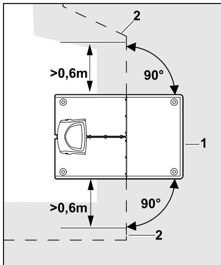
A monte e a valle della docking station (1) disporre il filo perimetrale (2) a **una distanza di 0,6 m** in posizione diritta e ad angolo retto rispetto alla piastra di fondo. Quindi seguire il bordo della superficie di taglio dell'erba con il filo perimetrale.
