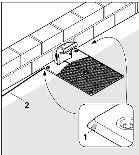
Qualora si volesse installare la docking station alla parete, mediante una pinza universale è necessario fessurare un listello (1) a sinistra o a destra nella piastra di fondo per creare spazio per il cavo di rete (2).
