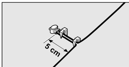
Come protezione antitrazione cavo, fissare il filo perimetrale al terreno con due elementi di ancoraggio, come mostrato in figura.
