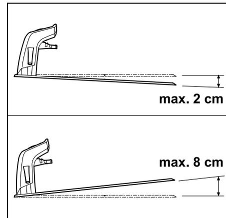
La station de base doit être inclinée au maximum de 8 cm à l'arrière et de 2 cm à l'avant.
