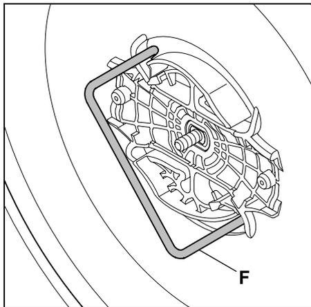
Inserire l'estrattore (F) e ruotare in senso antiorario fino all'arresto.
