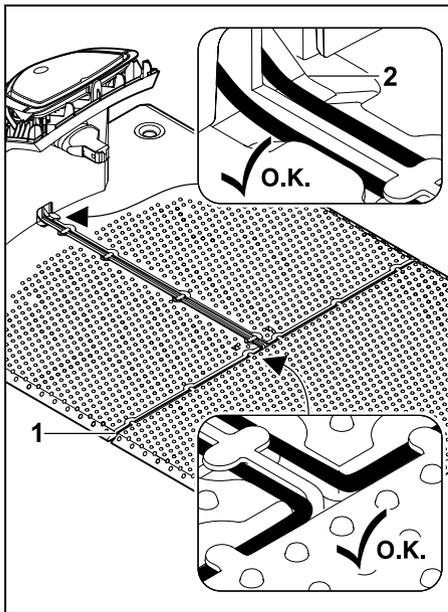
Inserire il filo perimetrale (1) nelle guide cavo della piastra di fondo e infilarlo attraverso la presa (2).
