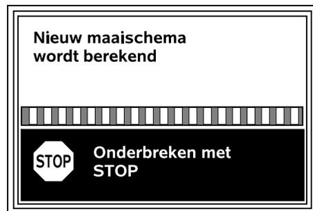
Een nieuw maaischema wordt berekend. Met de rode STOP-toets op de bovenkant van het apparaat kan de procedure worden afgebroken.
