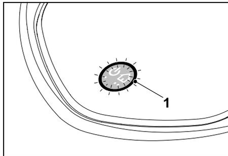
Als de begrenzingsdraad goed geïnstalleerd is en het dockingstation op het elektriciteitsnet aangesloten is, brandt de led (1).
