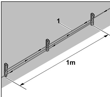
Disporre il filo perimetrale (1) su una lunghezza di circa 1 m tra 2 elementi di ancoraggio, come indicato in figura. Fissare la riserva di filo al centro con un ulteriore elemento di ancoraggio al terreno.
