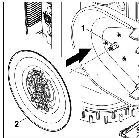
Messerwelle (1) und Aufnahme an der Mitnehmerscheibe (2) gründlich reinigen. Mitnehmerscheibe bis zum Anschlag auf die Messerwelle schieben.
