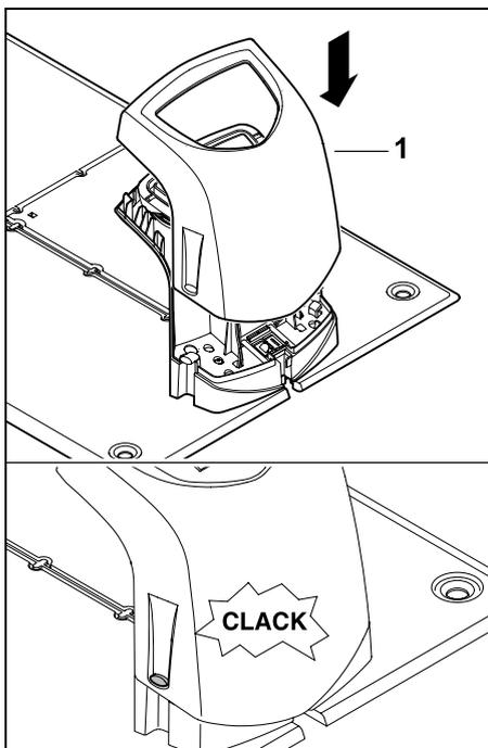
Plaats de afdekking (1) op het dockingstation en laat deze vastklikken – voorkom dat er kabels bekneld raken.
