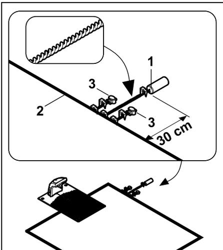
Bevestig de AKM 100 (1) op 30 cm afstand buiten het maaivlak met een bevestigingspen. Draai de draaduiteinden tot aan het maaivlak in elkaar en bevestig ze met een bevestigingspen.
