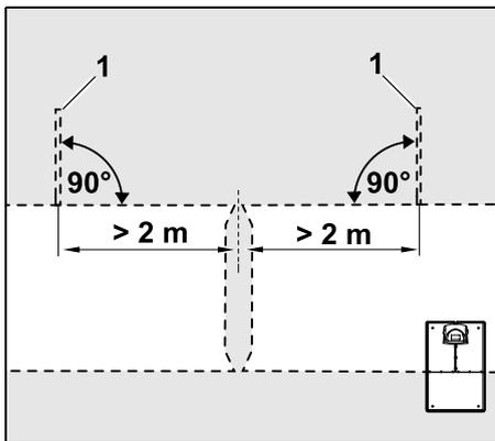
Links en rechts naast de toegang tot de doorgang moeten twee zoeklussen (1) in een hoek van 90° ten opzichte van de begrenzingsdraad worden geïnstalleerd, en wel altijd in het gedeelte van het maaivlak dat alleen via een doorgang kan worden bereikt. Minimale afstand tot de toegang tot de doorgang: **2 m**
