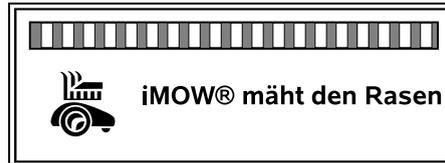
Während eines laufenden **Mähvorgangs** werden im Display der Text "iMOW® mäht den Rasen" und ein entsprechendes Symbol angezeigt. Die Textinformation und das Symbol werden an den jeweils aktiven Vorgang angepasst.
