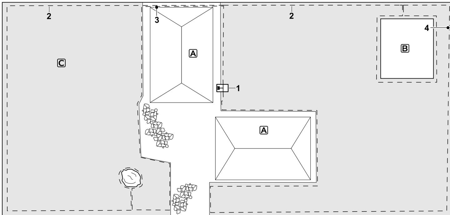
Zweigeteilte Mähfläche – Mähroboter kann nicht selbständig von einer zur anderen Mähfläche fahren.
