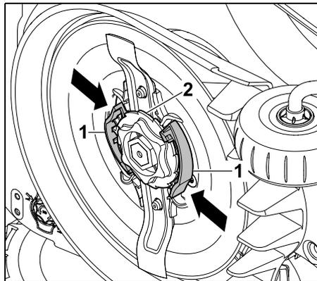
Beide Laschen (1) an der Mitnehmerscheibe mit einer Hand eindrücken und halten. Fixiermutter (2) mit der anderen Hand ausdrehen. Mähmesser zusammen mit Fixiermutter entnehmen.
