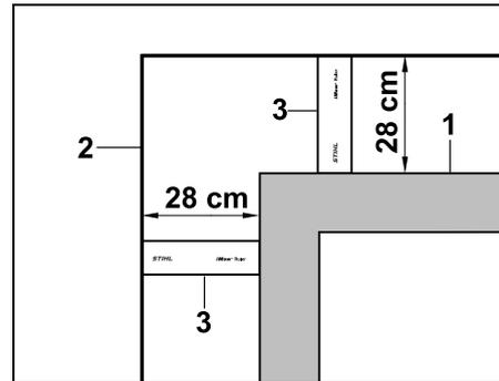
Bei der Verlegung um hohe Hindernisse wie Mauerecken oder Hochbeete (1) muss in den Ecken der Drahtabstand eingehalten werden, damit der Mähroboter nicht am Hindernis streift. Begrenzungsdraht (2) mit Hilfe des iMOW® Ruler (3) wie abgebildet verlegen.
