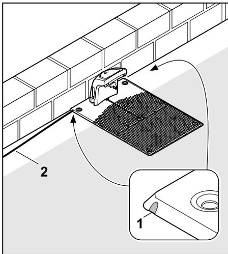
Als het dockingstation aan een wand wordt geïnstalleerd, moet in de bodemplaat met behulp van een combinatie tang naar keuze links of rechts een tussenstuk (1) worden uitgebroken, om plaats te maken voor de voedingskabel (2).
