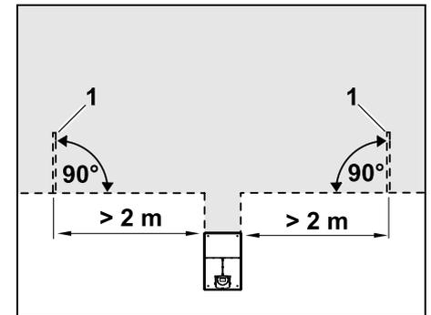
Links en rechts naast de toegang tot het dockingstation moeten twee zoeklussen (1) in een hoek van 90° ten opzichte van de begrenzingsdraad worden geïnstalleerd.
