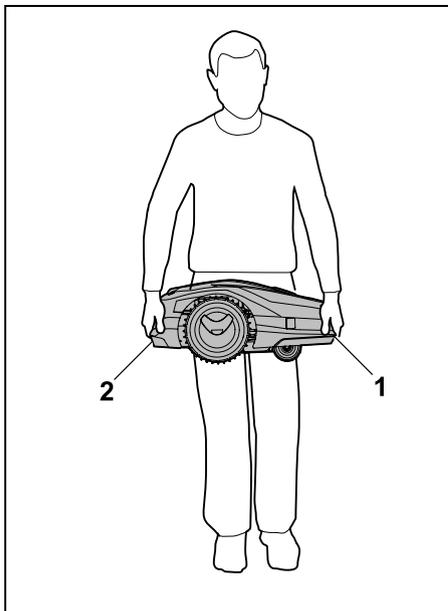
Soulever et porter le robot de tonte par la poignée de transport avant (1) et la poignée de transport arrière (2). Veiller à toujours détourner la lame de coupe de son corps et à laisser un espace suffisant entre la lame de coupe et le corps, en particulier au niveau des pieds et des jambes.
