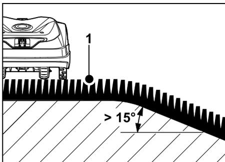
Als zich in het maaivlak een afhellend gedeelte met een helling van  $> 15^\circ$  bevindt waarin een begrenzingsdraad moet worden gelegd, wordt geadviseerd om de begrenzingsdraad (1) zoals afgebeeld in het vlakke gedeelte boven de rand van het terrein te leggen. De rand van het terrein en het afhellende gedeelte worden niet gemaaid.
