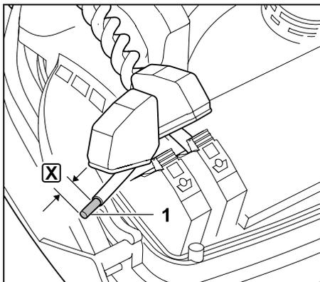
À l'aide d'un outil adéquat, dénuder l'extrémité de fil droite (1) sur la longueur indiquée X et torsader le toron.
