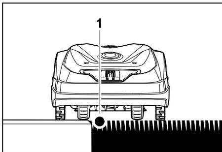
Le long d'obstacles franchissables comme des terrasses et des voies franchissables, le fil de délimitation (1) peut être posé **sans laisser de distance**. Le robot de tonte passera à l'extérieur de la zone de tonte avec une roue arrière.
