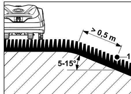
Si la zone de tonte présente une partie inclinée d'une déclivité de 5° - 15°, le fil de délimitation peut être posé dans la zone inclinée au-dessous du bord du terrain, comme indiqué sur la figure. Il faut tenir compte de la distance minimale (0,5 m) de l'arrêt du terrain au fil de délimitation pour un fonctionnement sans encombre du robot de tonte.
