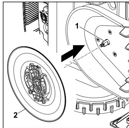
Pulire a fondo l'albero lama (1) e il supporto del disco trascinatore (2). Infilare il disco trascinatore sull'albero lama fino alla battuta.
