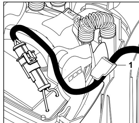
Stromkabel durch die Kabelführung (1) am Panel führen.
