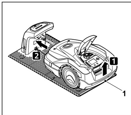
Sollevarlo leggermente il robot tosaerba utilizzando l'impugnatura per il trasporto (1) al fine di alleggerire il carico sulle ruote motrici. Spingere l'attrezzo appoggiato sulle ruote anteriori nella docking station.
