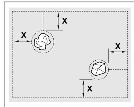
Les îlots de blocage doivent présenter un **diamètre minimum** de 56 cm. La **distance par rapport à la boucle de bordure (X)** doit être supérieure à 44 cm.
