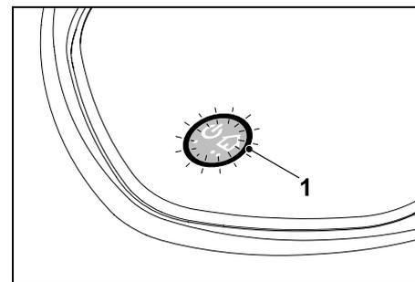
Si le fil de délimitation est correctement installé et que la station de base est branchée sur le secteur, le voyant (1) s'allume.
