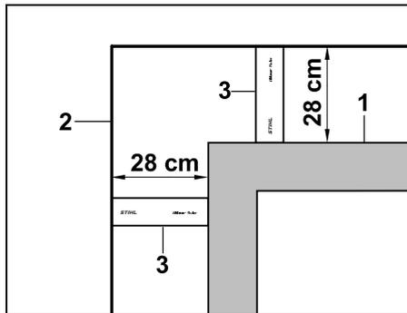
Bei der Verlegung um hohe Hindernisse (1) wie Mauerecken oder Hochbeete muss in den Ecken der Drahtabstand genau eingehalten werden, damit der Mähroboter nicht am Hindernis streift. Begrenzungsdraht (2) mit Hilfe des iMOW® Ruler (3) wie abgebildet verlegen.
