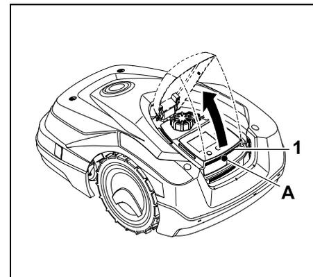
Pak de klep (1) bij de handgreep (A) vast en maak deze met een lichte ruk naar boven los. Open de klep tot aan de aanslag.
