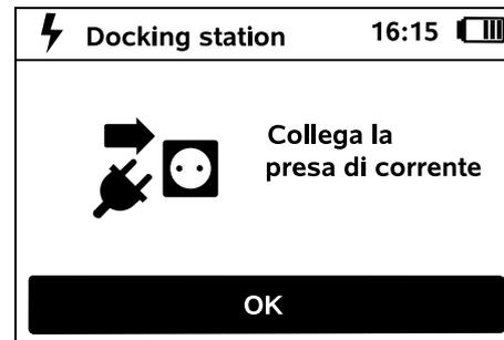
Collegare il connettore dell'alimentatore all'alimentazione di corrente, infine premere il tasto OK.
