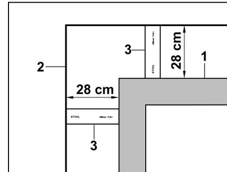
Lors de la pose autour d'obstacles hauts (1) tels que des murs ou des plate-bandes, il faut strictement respecter l'espacement de la bande dans les angles, afin que le robot de tonte n'effleure pas l'obstacle. Poser le fil de délimitation (2) à l'aide de l'iMOW® Ruler (3) comme indiqué sur la figure.
