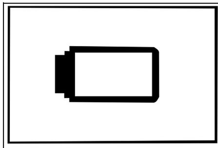
Ist die Akkuladung zu gering, erscheint das entsprechende Akkusymbol. In diesem Fall Mähroboter zum Aufladen in die Dockingstation stellen.
