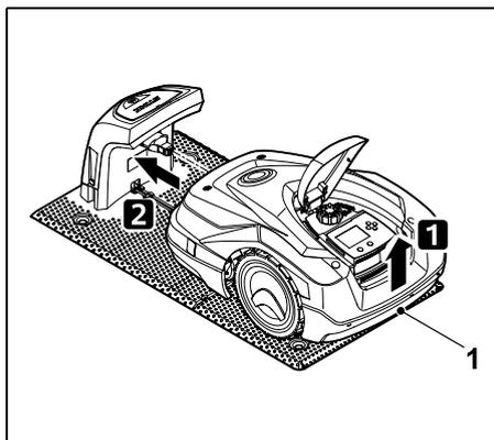
Til de robotmaaier aan de handgreep (1) iets op om de aandrijfwielen te ontlasten. Schuif het apparaat op de voorwielen in het dockingstation.
