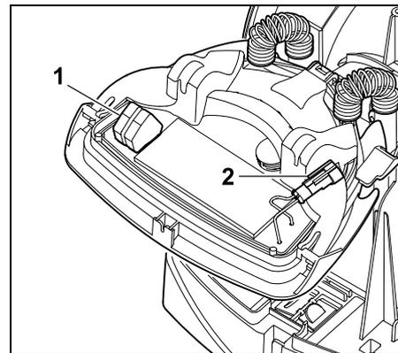
Les branchements pour le fil de délimitation (1) et le câble d'alimentation (2) sont protégés contre les intempéries lorsque le panneau est fermé.
