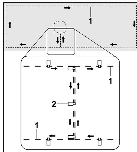
Nei tratti di collegamento il filo perimetrale (1) viene disposto in parallelo, i fili non devono incrociarsi e devono essere a contatto. Fissare al terreno il tratto di collegamento con un numero sufficiente di elementi di ancoraggio (2).
