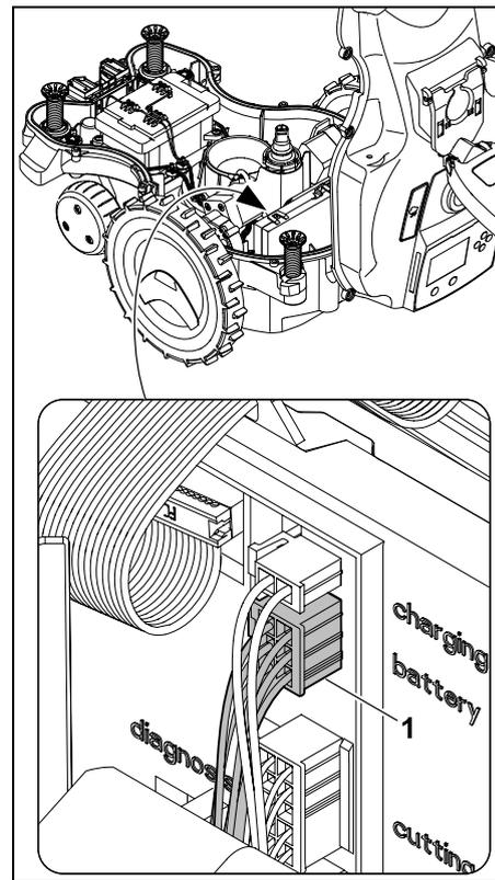
Estrarre il connettore del cavo (1) (batteria).
