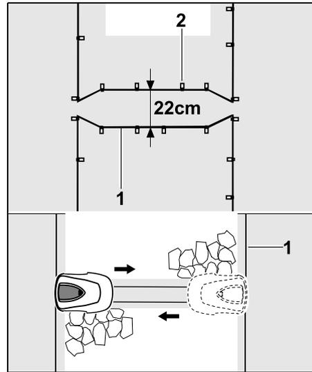
In doorgangen wordt de begrenzingsdraad (1) parallel gelegd en met voldoende bevestigingspennen (2) aan de grond vastgezet. Aan het begin en aan het einde van de doorgang moet ook een trechervormige toegang en uitgang worden geïnstalleerd.
