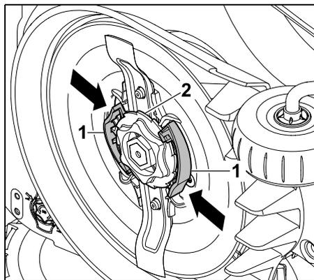
Premere entrambe le linguette (1) e inserirle sul disco trascinatore con una mano, quindi bloccarle. Svitare il dado di fissaggio (2) con l'altra mano. Rimuovere la lama insieme al dado di fissaggio.
