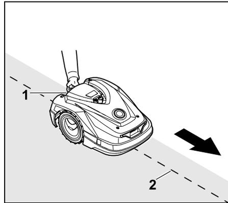
Rijd de rand van het maaivlak met de robotmaaier vanaf het dockingstation **rechtsom** af. Til daarvoor het apparaat aan de handgreep achter (1) iets op om de aandrijfwielen te ontlasten. Volg met de robotmaaier op de voorwielen de begrenzingsdraad (2). Zorg ervoor dat de begrenzingsdraad (2) onder de draadsensoren loopt. De draadsensoren zijn afgeschermd links- en rechtsvoor op de robotmaaier gemonteerd.
