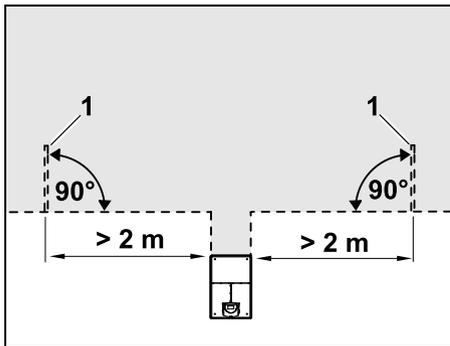
Links und rechts neben der Zufahrt zur externen Dockingstation sind zwei Suchschleifen (1) in einem Winkel von 90° zum Begrenzungsdraht zu installieren. Mindestabstand zur Zufahrt: 2 m
