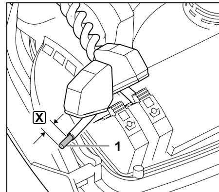
Rechtes Drahtende (1) mit einem geeigneten Werkzeug auf die angegebene Länge **X** abisolieren und Drahtlitze verdrillen.
