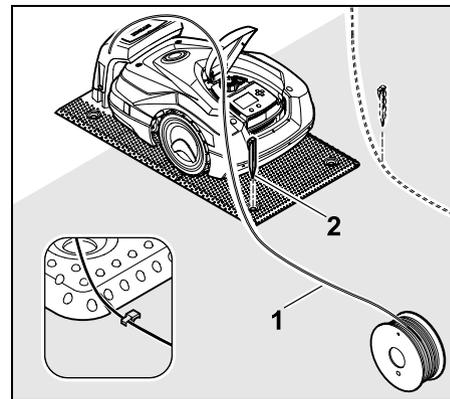
À l'aide d'un piquet de fixation (2), fixer au sol le fil de délimitation (1) à **gauche** ou à **droite** derrière la plaque de base, directement à côté d'une sortie de fil.
