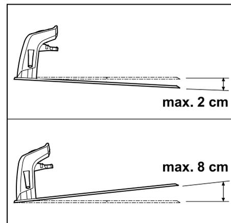
Die Dockingstation darf maximal 8 cm nach hinten und 2 cm nach vorne geneigt sein.
