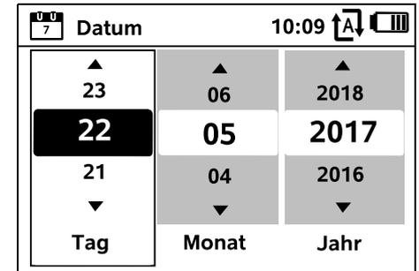
Einstellwerte können durch Drücken des Steuerkreuzes verändert werden. Der aktuelle Wert ist schwarz hervorgehoben. Mit der OK-Taste erfolgt die Bestätigung aller Werte.
