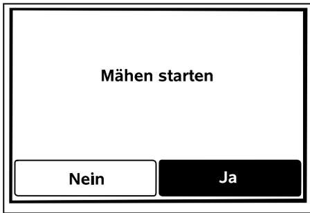
Falls der Abschluss der Erstinstallation außerhalb der Aktivzeit erfolgt, kann durch Drücken der OK-Taste ein Mähvorgang gestartet werden. Falls der Mähroboter nicht mähen soll, "Nein" auswählen.
