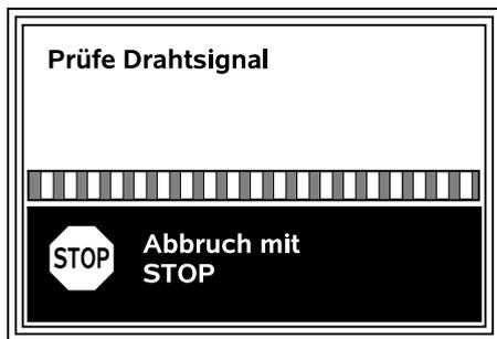
Das Prüfen des Drahtsignals kann mehrere Minuten dauern. Mit der roten STOP-Taste auf der Geräteoberseite wird das Koppeln abgebrochen, der vorige Schritt des Installationsassistenten wird aufgerufen.
