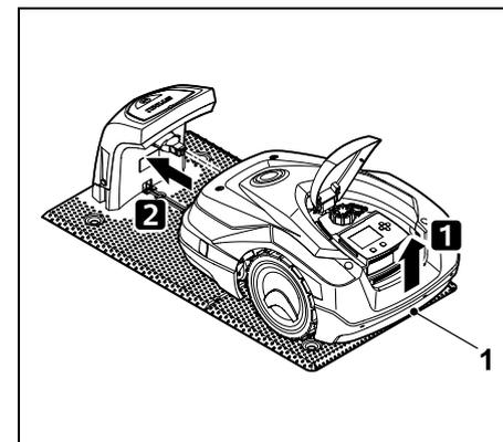
Soulever légèrement le robot de tonte par la poignée de transport (1) afin de décharger les roues motrices. Pousser l'appareil appuyé sur ses roues avant dans la station de base.
