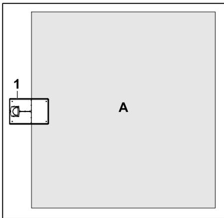
Het dockingstation (1) wordt binnen het maaivlak (A), direct aan de rand geïnstalleerd.
