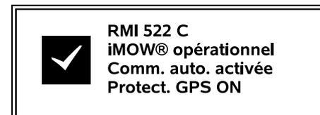
Dans la partie inférieure de l'écran sont affichés le nom du robot de tonte (⇒ 10.), le texte « iMOW® prêt à fonctionner » ainsi que le symbole représenté, le statut automatique (⇒ 15.4) et des informations sur la protection GPS (⇒ 5.9).
