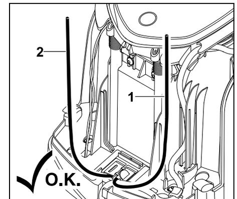
Linkes Drahtende (1) und rechtes Drahtende (2) auf dieselbe Länge kürzen. Länge vom Drahtauslass bis zum Drahtende: **40 cm**
