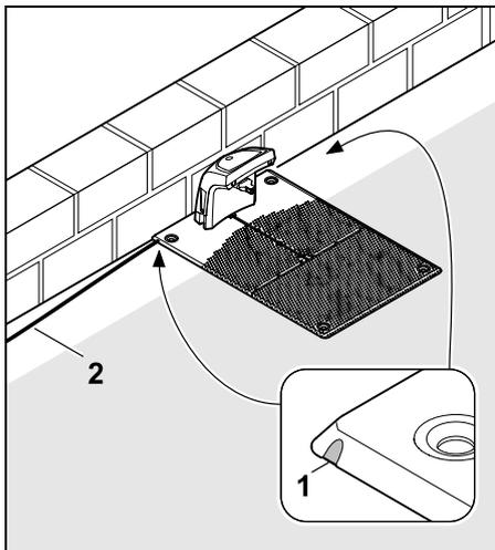
Falls die Dockingstation an einer Wand installiert wird, muss in der Bodenplatte mit Hilfe einer Kombizange wahlweise links oder rechts ein Steg (1) ausgebrochen werden, um Platz für das Netzkabel (2) zu schaffen.
