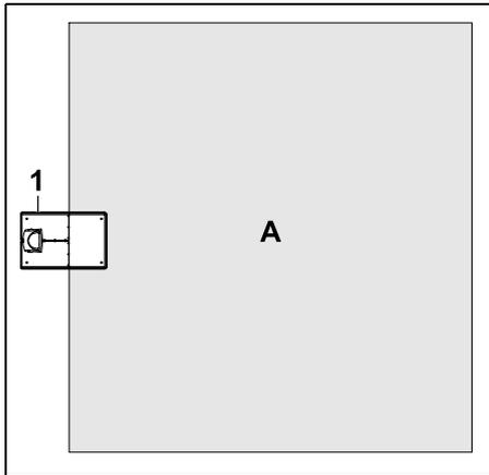
La station de base (1) est installée à l'intérieur de la zone de tonte (A), directement au bord.
