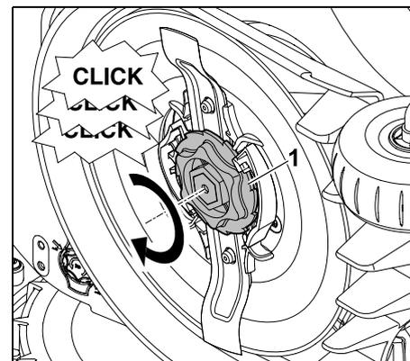
Avvitare il dado di fissaggio (1) fino alla battuta. Durante il serraggio sono percepibili diversi clic. Controllare che la lama sia posizionata in sede in modo sicuro scuotendola con cautela.
