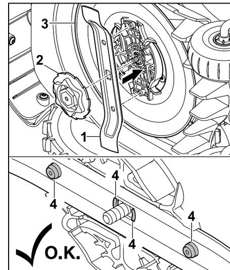
Placer la lame de coupe (1) et l'écrou de fixation (2) sur le disque d'entraînement (3) comme indiqué sur la figure. Veiller à bien positionner les ergots (4) dans la lame de coupe.
