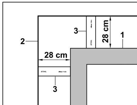
In fase di disposizione attorno a ostacoli alti (1), quali angoli di muro oppure aiuole alte, è necessario rispettare con cura la distanza filo negli angoli così da evitare che il robot tosaerba strisci contro l'ostacolo stesso. Disporre il filo perimetrale (2) con l'ausilio della dima distanziatrice iMOW® (3) come indicato in figura.
