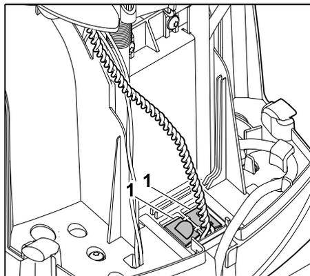
Sluit de deksels van de kabelgoot (1).
