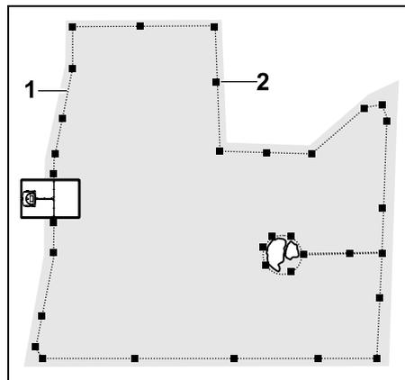
Disporre il filo perimetrale (1) attorno all'area taglio e attorno agli eventuali ostacoli presenti (⇒ 12.9) e fissarlo al terreno con degli elementi di ancoraggio (2). Controllare le distanze con l'ausilio della dima distanziatrice iMOW®. (⇒ 12.5)
