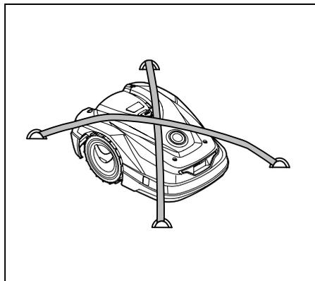
Sécuriser le robot de tonte sur la surface de charge. À cet effet, fixer l'appareil à l'aide d'équipements de fixation appropriés (sangles, câbles), comme indiqué sur la figure.
