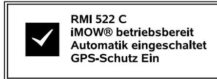
Im unteren Bereich der Anzeige werden der Name des Mähroboters (⇒ 10.), der Text "iMOW® betriebsbereit" zusammen mit dem abgebildeten Symbol, der Automatik-Status (⇒ 15.4) und Informationen zum GPS-Schutz (⇒ 5.9) angezeigt.
