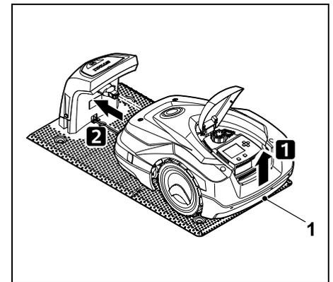
Mähroboter am Tragegriff (1) etwas anheben, um die Antriebsräder zu entlasten. Gerät auf die Vorderräder aufgestützt in die Dockingstation schieben.
