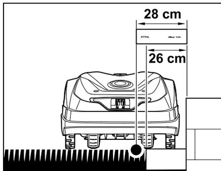
Poser le fil de délimitation à une distance de 28 cm par rapport à l'obstacle. Pour que le bord de la pelouse soit entièrement tondu, les bordures de pierre doivent avoir au moins 26 cm de largeur. Si des bordures en pierre plus larges sont posées, le bord de la pelouse est tondu avec encore plus de précision.
