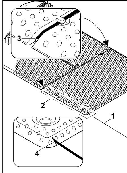
Begrenzungsdraht (1) im Bereich (2) unter der Bodenplatte verlegen. Dazu Draht in die Drahtauslässe (3, 4) einfädeln – bei Bedarf Heringe lockern.
