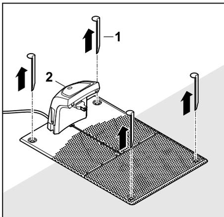
Extraire les baïonnettes (1), enlever la station de base (2) de la pelouse avec le bloc d'alimentation branché, la nettoyer soigneusement (à l'aide d'un chiffon humide) et la remiser.
