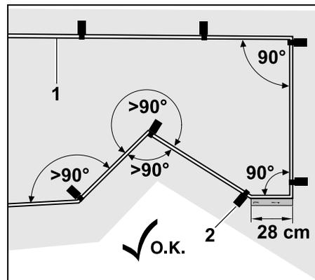
Éviter de poser le fil à des angles aigus (inférieurs à 90°). Au niveau des angles pointus de la pelouse, fixer le fil de
