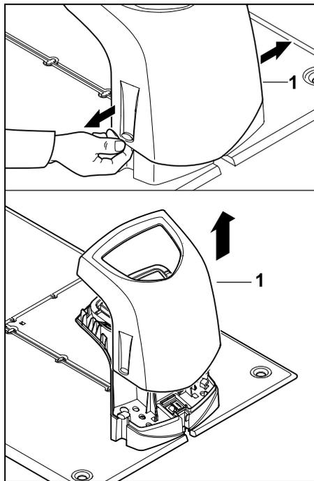
Écarter légèrement le capot (1) à gauche et à droite comme indiqué sur la figure et le déposer par le haut.
