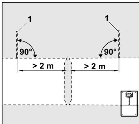
A sinistra e a destra accanto all'accesso del passaggio devono essere installati due circuiti guida (1) a un angolo di 90° rispetto al filo perimetrale, ovvero sempre nella parte dell'area taglio raggiungibile solamente attraverso un passaggio. Distanza minima dall'ingresso del passaggio: **2 m**
