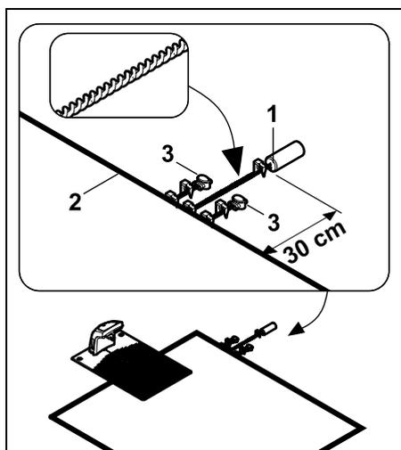
Fissare l'AKM 100 (1) fuori dall'area taglio, a una distanza di 30 cm, utilizzando un elemento di ancoraggio. Intrecciare le estremità del filo fino all'area taglio e fissarle con un elemento di ancoraggio.
