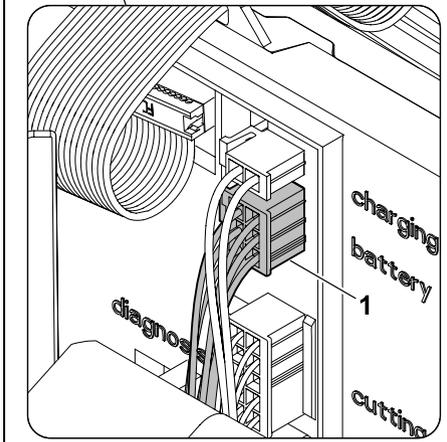
Trek de kabelstekker (1) (accu) los.
