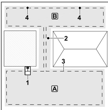
La station de base (1) est installée dans la zone de tonte **A**. La zone de tonte **B** est reliée à la zone de tonte **A** par un couloir (2). Le fil de délimitation (3) peut être traversé par le robot de tonte. Définir des points de départ (4) pour traiter la zone de tonte **B**. (⇒ 11.14)
