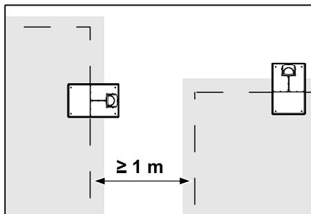
Les zones de tonte ne doivent pas se chevaucher. Respecter une distance minimale de  $\geq 1$  m entre les fils de délimitation de deux zones de tonte.
