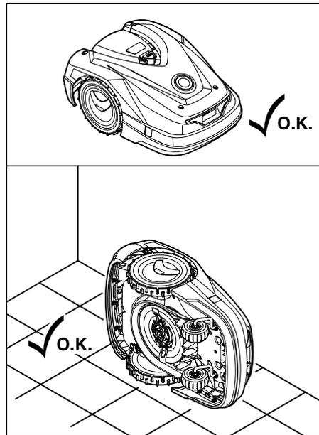
Zet het apparaat voor het reinigen van de **bovenkant** (kap, klep) op een vlakke, stevige en horizontale ondergrond. Kantel de robotmaaier voor het reinigen van de **onderkant** (maaimes, maaierwerk) zoals afgebeeld op de linker- of rechterkant en zet deze tegen een muur.
