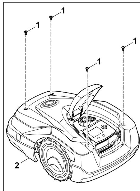
Schrauben (1) an der Abdeckung (2) ausdrehen und entnehmen. Abdeckung (2) nach oben abziehen.
