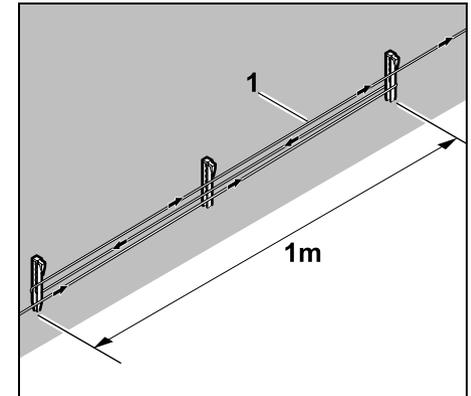
Begrenzungsdraht (1) über eine Länge von ca.  $1\text{ m}$  zwischen 2 Fixiernägeln wie abgebildet verlegen. Drahtreserve in der Mitte mit einem weiteren Fixiernagel am Boden festmachen.
