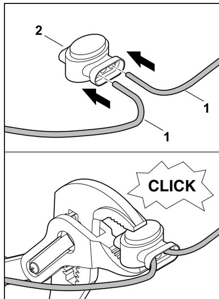
Insérer les extrémités de fil non raccordées et non isolées (1) dans le connecteur de fil (2) jusqu'en butée. Comprimer le connecteur de fil à l'aide d'une pince adéquate – Veiller à ce qu'il s'enclenche correctement.
