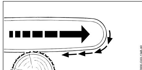
Wenn mit der Unterseite der Führungsschiene gearbeitet wird, wird die Motorsäge weg vom Benutzer gezogen.
