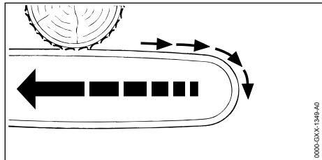
Lorsqu'on travaille avec le côté supérieur du guide-chaîne, la tronçonneuse est repoussée en direction de l'utilisateur.
