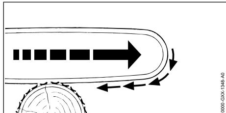
Als met de onderzijde van het zaagblad wordt gewerkt, wordt de kettingzaag weggetrokken van de gebruiker.
