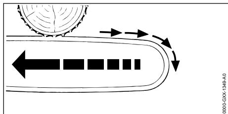
Als met de bovenzijde van het zaagblad wordt gewerkt, wordt de kettingzaag naar de gebruiker toe gestoten.
